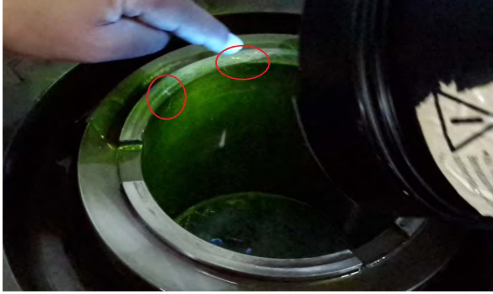
Resim 18. Ultraviyole Iřık Altında atlakların Grnm
