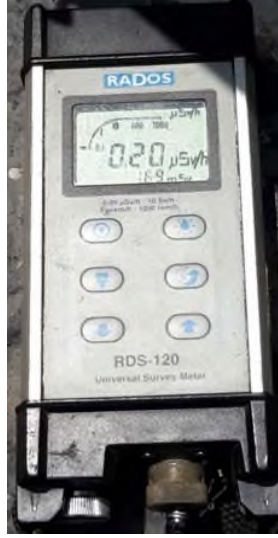
Resim 8. Ortamdaki Radyasyon Seviyesini Tespit Eden Radyakmetre
