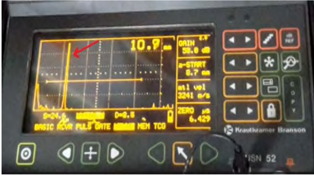
Resim 16. Ultrasonik Cihazdaki Süreksizlik Görüntüsü
