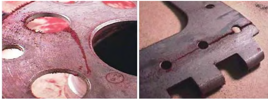
Resim 4. Demir Tozlarının Çatlaklar Üzerindeki Görünüşleri (Salma, 2011)
