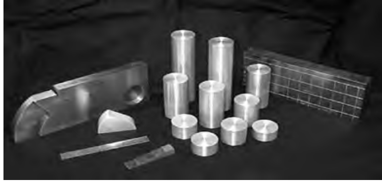
Resim 2. Ultrasonik Muayenede Kullanılan Referans Bloklar
