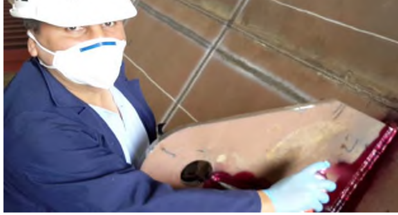
Resim 14. Yüzeye Penetrant Uygulanması
