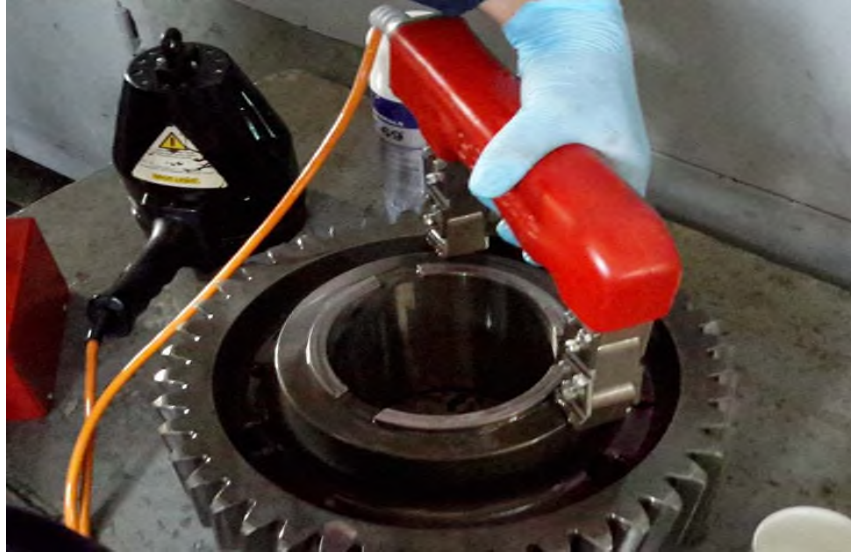
Resim 17. Yoke Cihazı İle Manyetik Alan Oluşturulması
