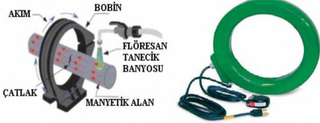
Şekil 8. Bobin ile Parçada Oluşturulan Manyetik Alan (Onursal, 2010)
