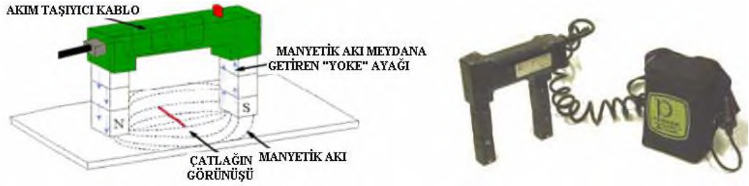
Şekil 7. Yoke Cihazı ile Manyetik Parçacık Kontrolü (Doğru, 2014)
