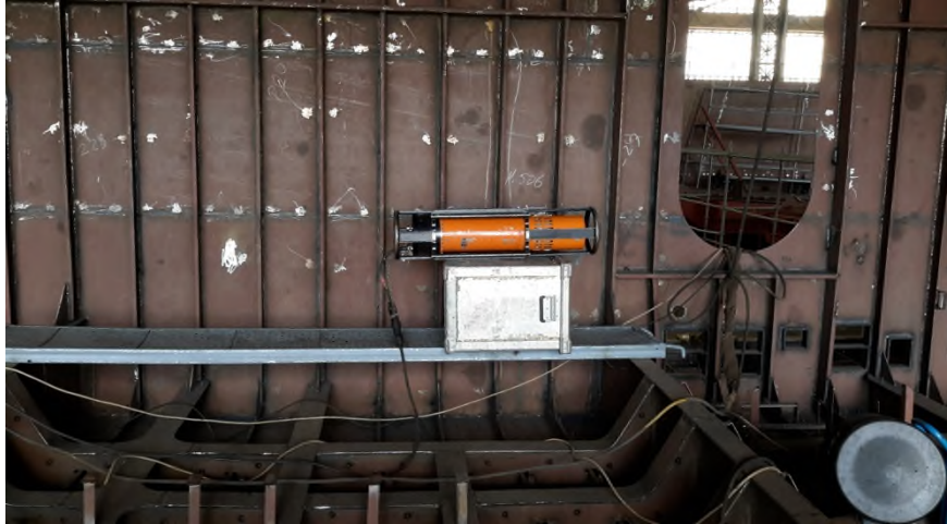
Resim 6. Gemi Bloklarının Kaynak Kısımlarının X-İşını Yöntemiyle Kontrolü
