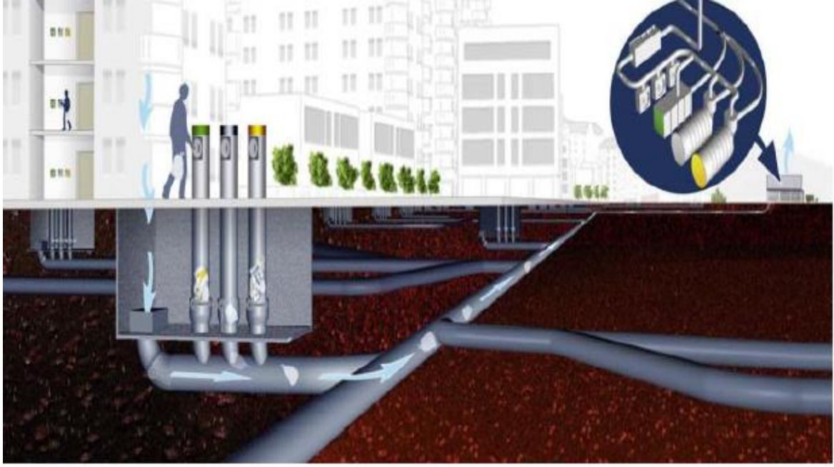
Resim 3. Sabit Pnömatik (Vakumlu) Çöp Toplama Sistemi (Yaşaroğlu, 2014)
