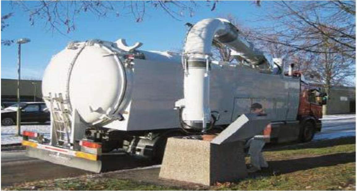
Resim 4. Mobil Vakumlu Çöp Toplama Sistemi (Yaşaroğlu, 2014)
