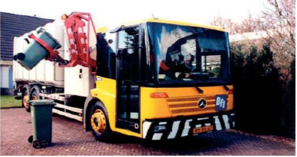
Resim 5. Tam Otomatik Çöp Toplama Mekanizması (Yaşaroğlu, 2014)
