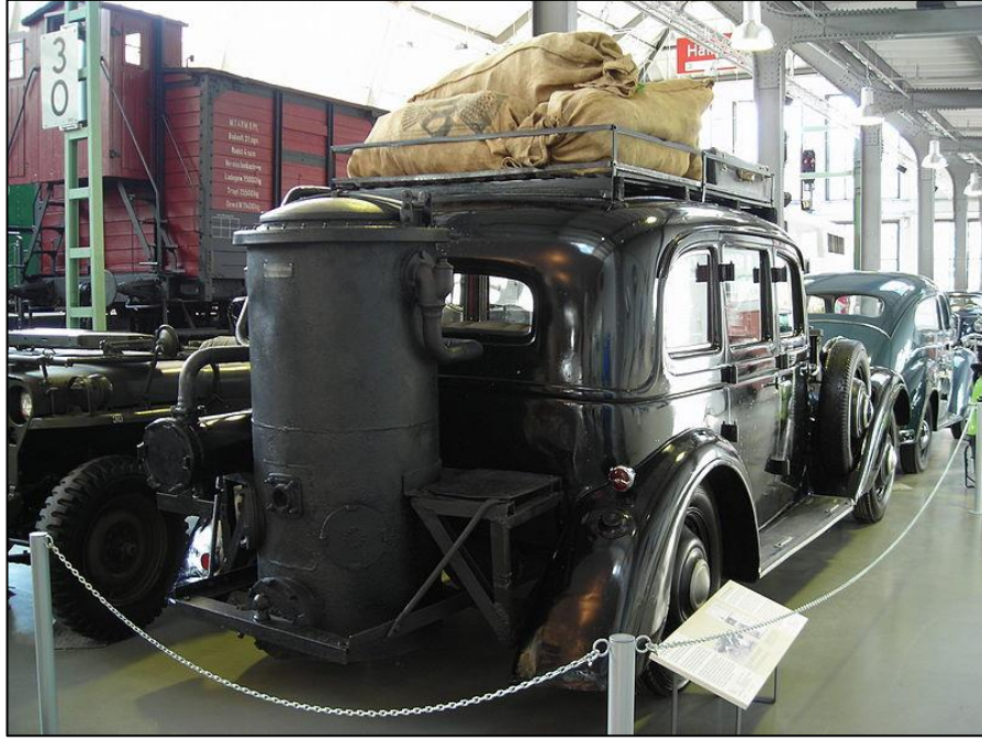
Resim 1: 1930'lu yıllarda Almanya'da geliştirilen, biyokütle yakıt kullanan Adler Diplomat marka otomobil (Oswald, 2001).
