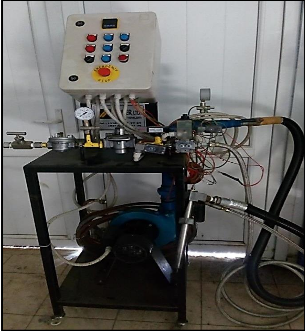
Resim 4: Ateşleyişi ve Isıtıcı Brülör
