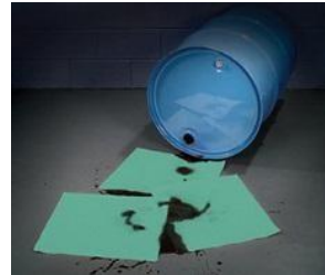
Resim 36: Kimyasal dökülmede emici ped uygulaması
