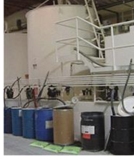
Resim 35: Kimyasal dökülmede yastık uygulaması
