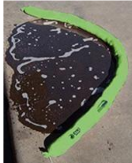
Resim 34: Kimyasal dökülmede sosis uygulaması
