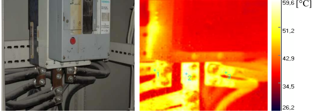
Resim 4.28. Standart ve kızılötesi termal kamera fotoğrafları 27
