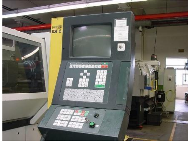
Resim 2.7. Enjeksiyon kontrol ünitesi (MEB, 2006)
