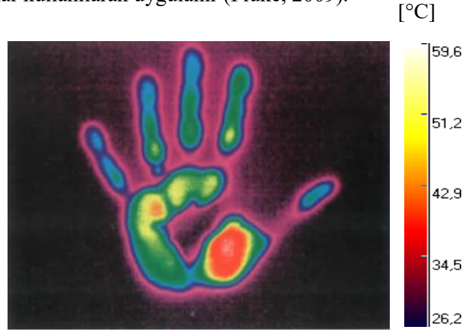
Resim 2.8. Bir duvarın yüzeyine elden iletilmiş olan kalıntı ısının termal görüntüsü.
