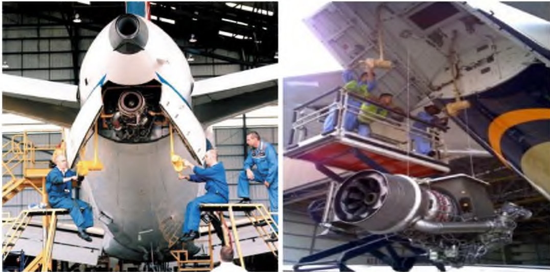
Resim 78: Caraskal ile APU söküm – takımı yapan teknisyenler
