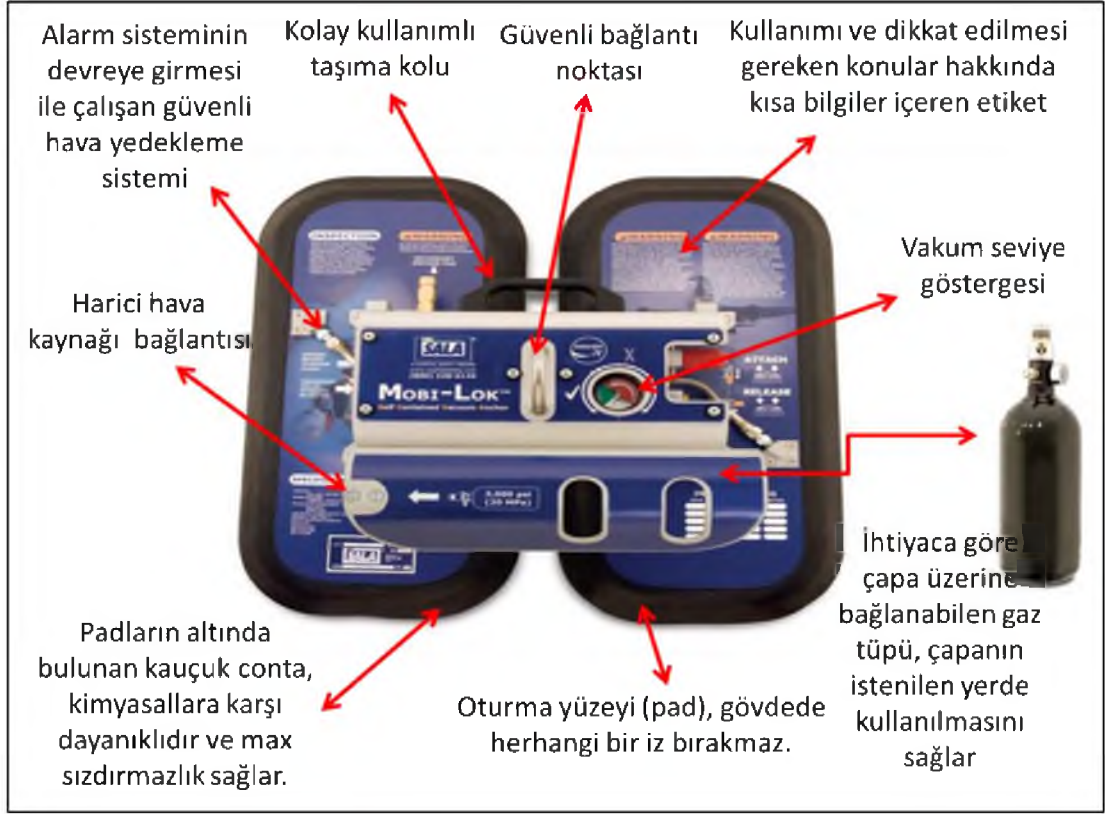
Resim 30: Mobilok çapası ve özellikleri (THY Teknik A.Ş. teknik eğitim dokümanları)
