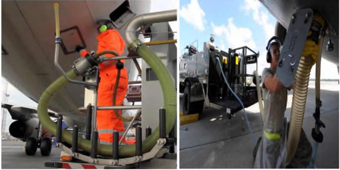
Resim 120: Waste tank boşaltımı (THY Teknik A.Ş. teknik eğitim dokümanları)
