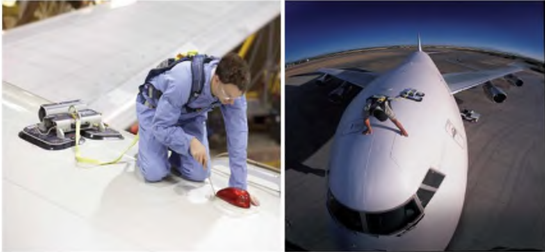
Resim 32: Uçağın kavisli yüzeylerinde de kullanılabilen mobilok sistemi uygulamaları
