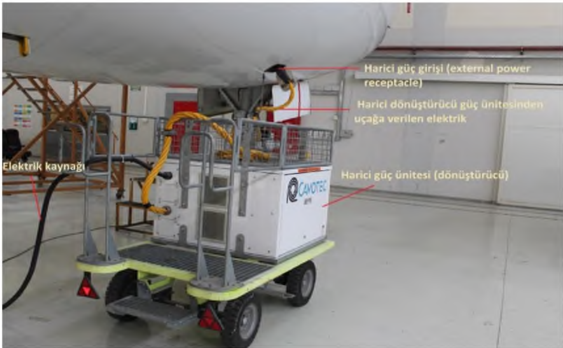
Resim 96: Hangar içinde kullanılan harici güç ünitesi (dönüştürücü)
