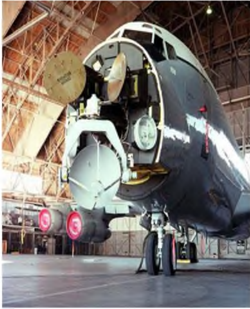
Resim 44: Radomda bulunan ekipmanlar Resim 45: Radomdan yayılan radyasyon (THY Teknik A.Ş. teknik eğitim dokümanları)
