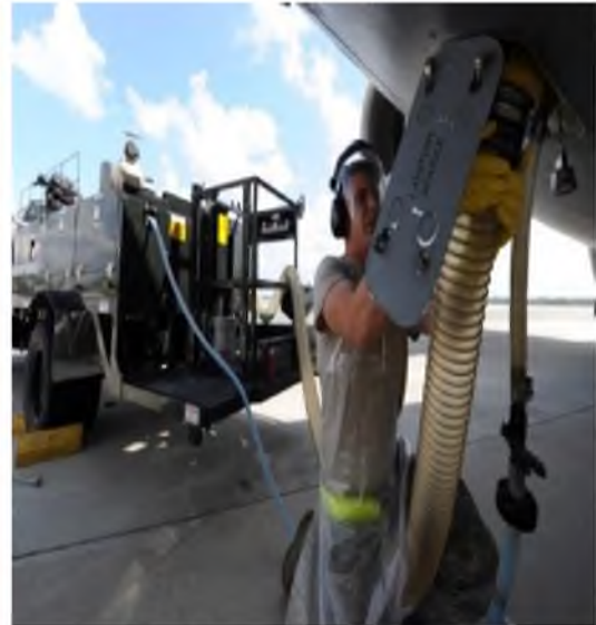
Resim 75: Waste tank boşaltımı
