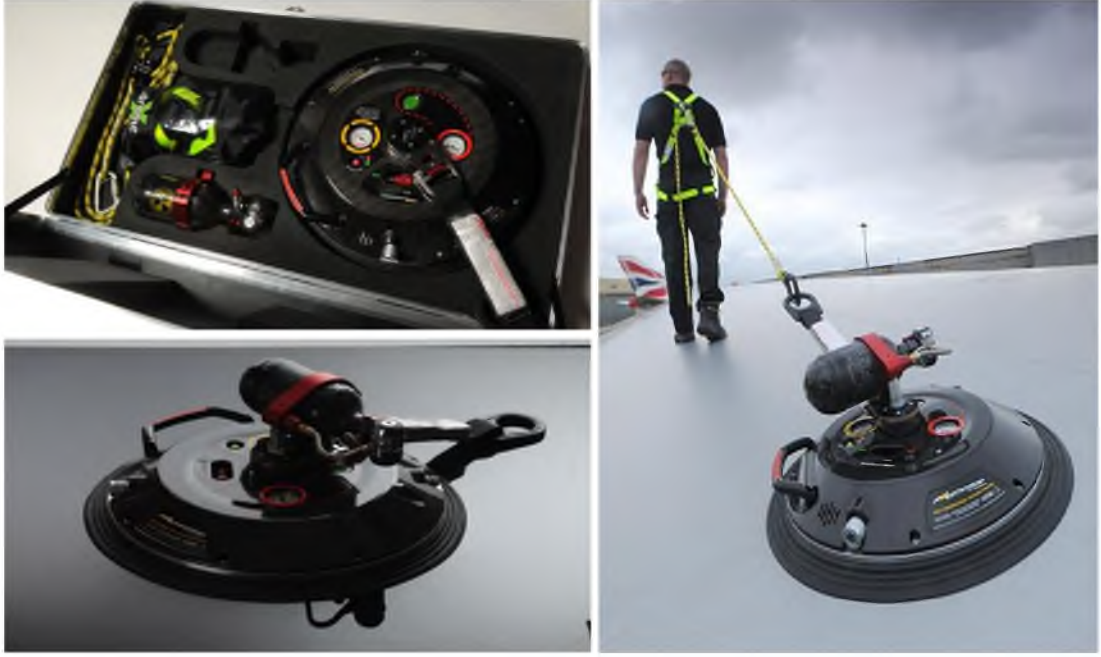
Resim 28: Hızlı ve kısa süreli bakımlar için kullanılan wingrip sistemi (THY Teknik A.Ş. teknik eğitim dokümanları)
