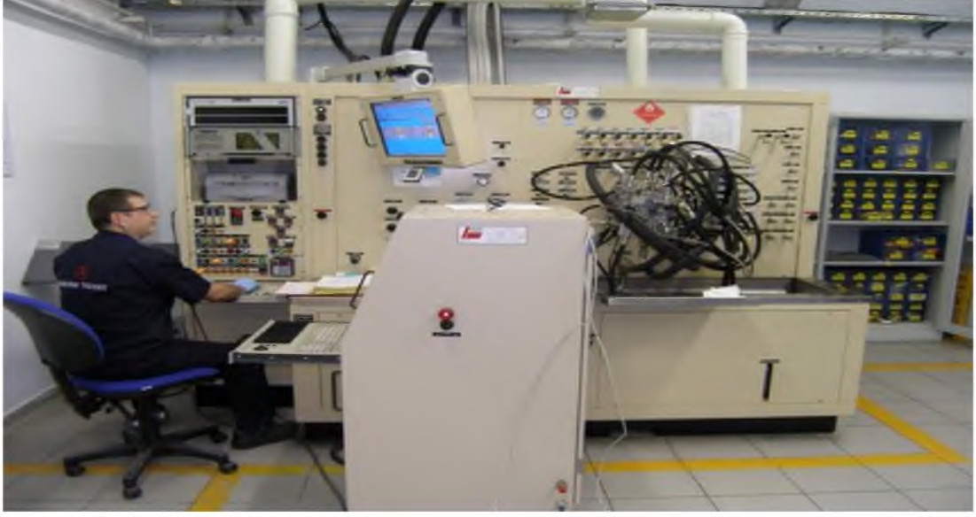
Resim 11: Yakıt boruları test ünitesi
