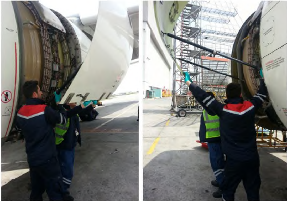
Resim 137: Motor kaportalarını açan teknisyenler
