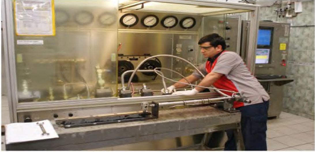
Resim 8: Hidrolik boruların basınç testi
