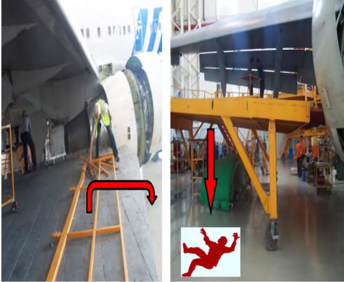
Resim 109: Kanat altı sehvasından düşme sonucu meydana gelen iş kazası
