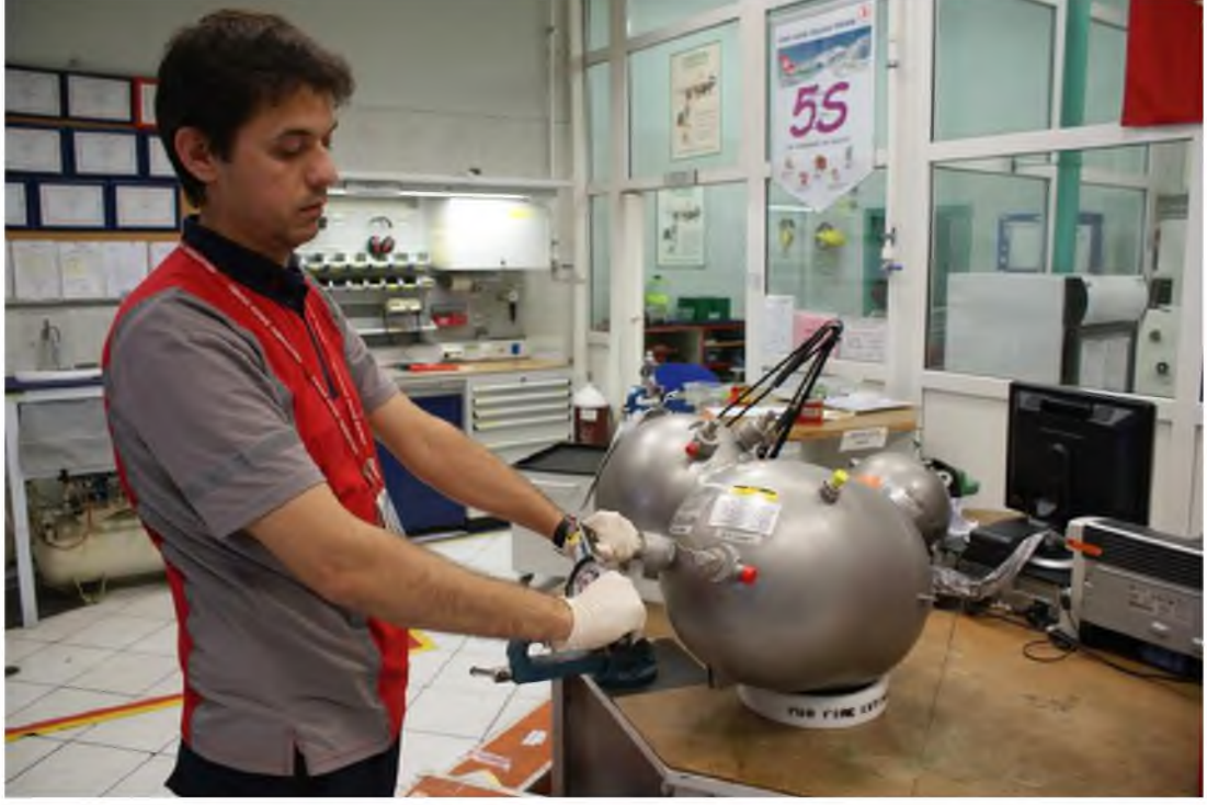
Resim 18: Kargo yangın tüpü kontrolü
