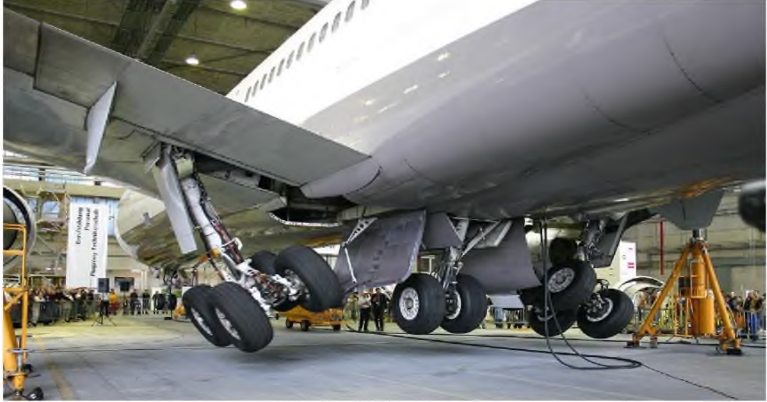
Resim 77: Jack'a alınmış uçağın iniş takımı freefall (serbest düşüş) testi
