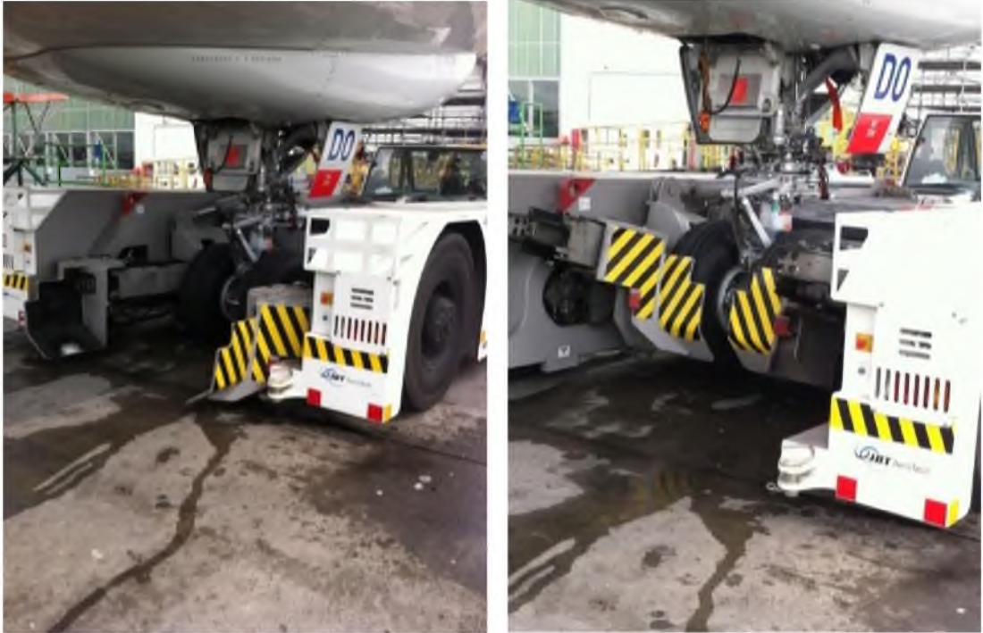
Resim 80: Hidrolik sistemli push back aracı ile uçak çekme
