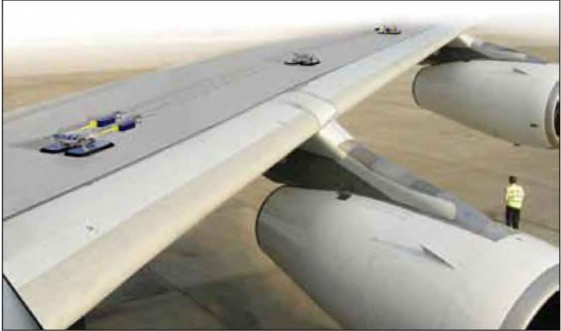
Resim 33: Kanat üzerinde oluşturulmuş mobilok ikiz yaşam hattı
