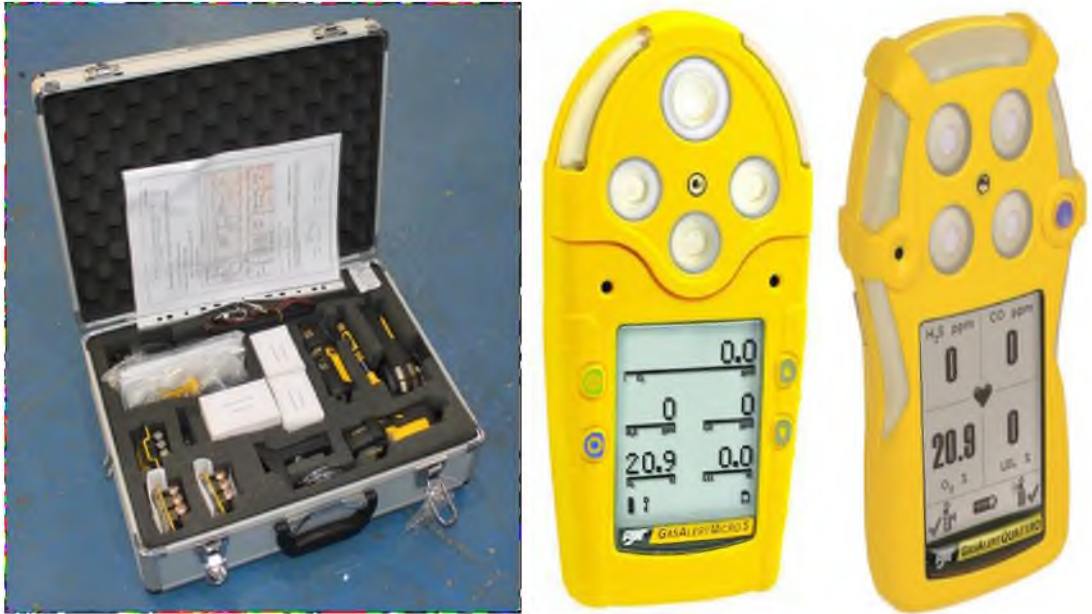
Resim 71: Gaz algılama ekipmanları (THY Teknik A.Ş. teknik eğitim dokümanları)
