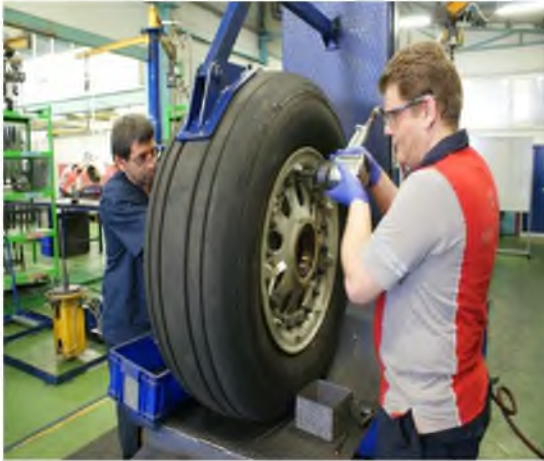
Resim 12: Jant söküm işlemi
