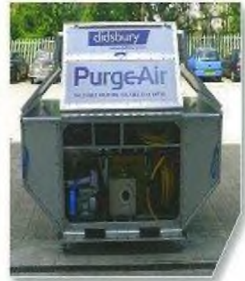
Resim 61: Purge – air sisteme ait ekipmanları barındıran konteynır
