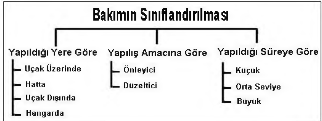
Şekil 5: Uçak bakımlarının sınıflandırılması
