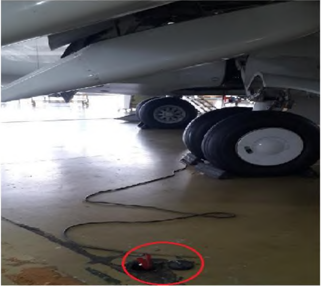
Resim 134: Uçağın topraklama hattına bağlanması (NAZLIOĞLU A. – 2014)
