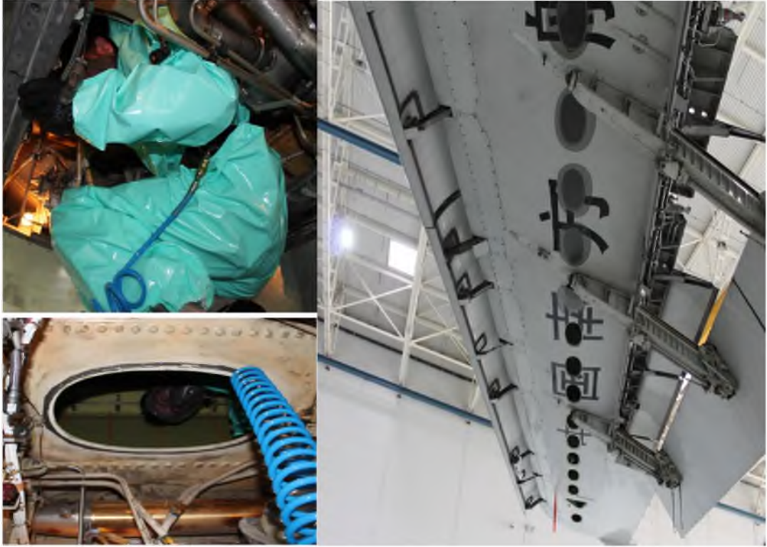
Resim 136: Kanatta bulunan yakıt tanklarına ait giriş kapakları
