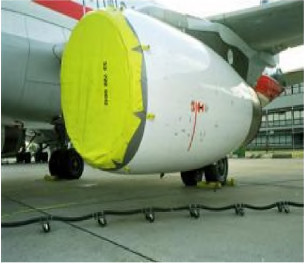
Resim 84: Motor girişinin kapatılması (NAZLIOĞLU A. – 2014)
