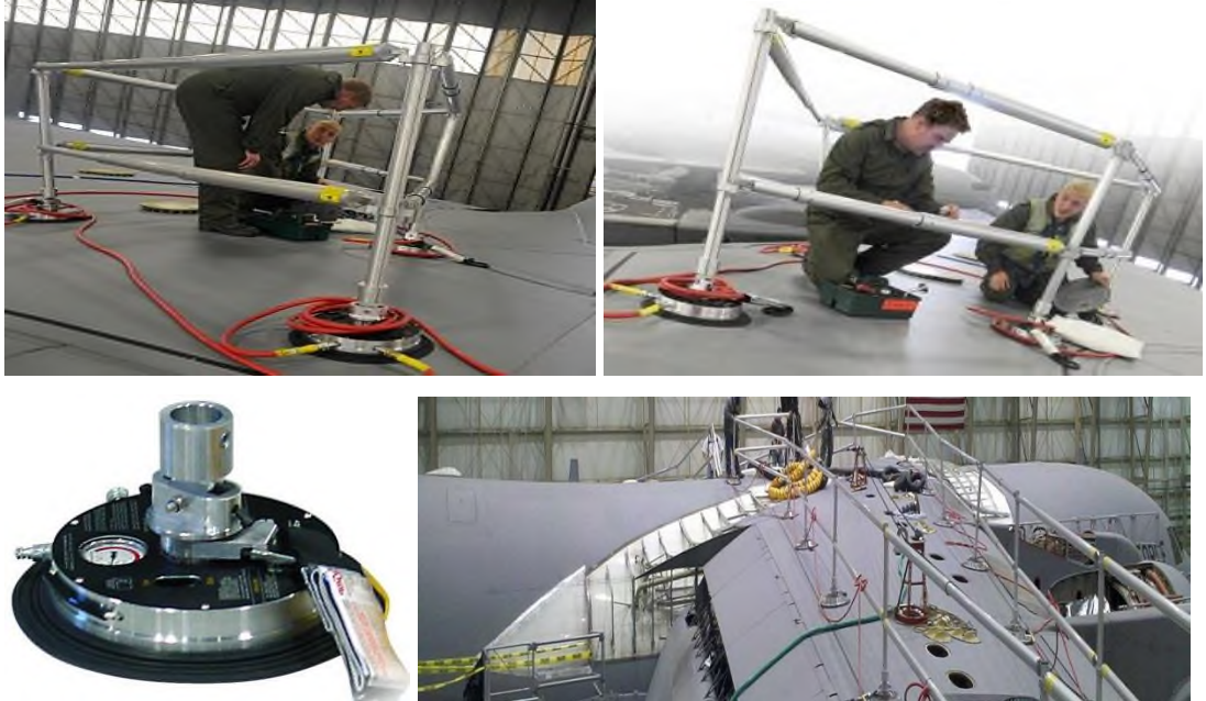
Resim 56: Wingripkorkuluk ve bariyer sistemi
