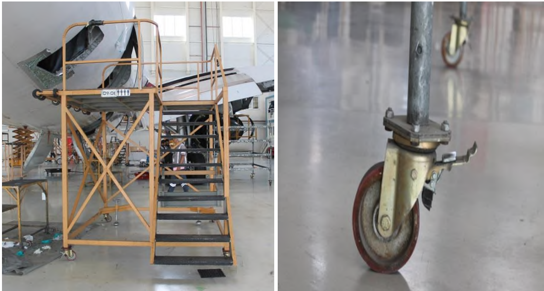
Resim 42: Arka kargo sehpası ve lastik – fren tertibatı
