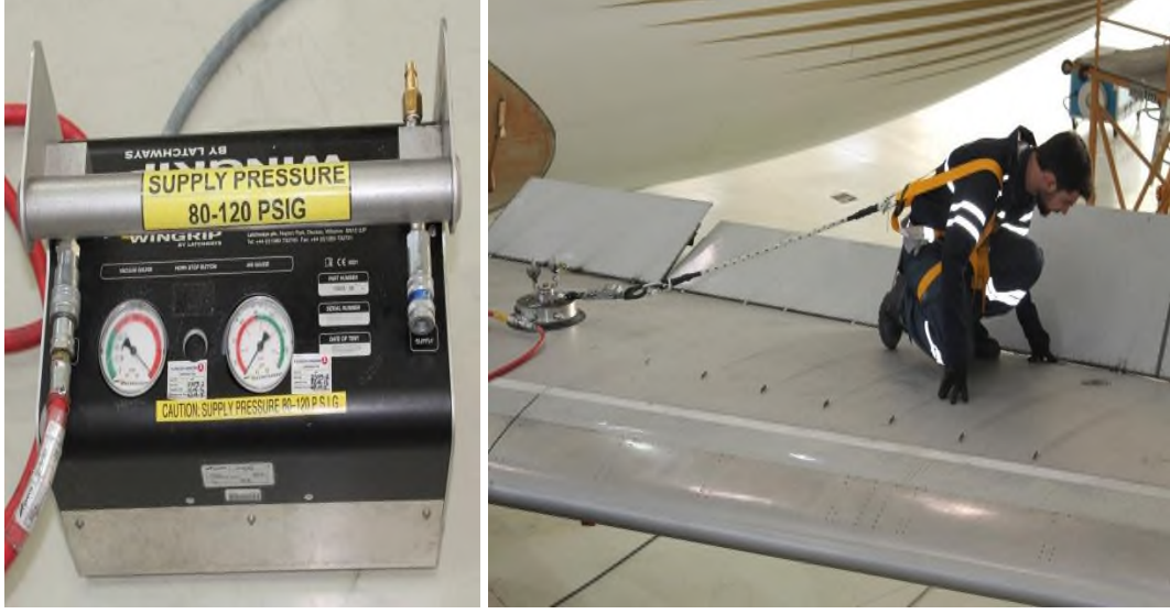
Resim 55: Çapalara giden havanın basıncını ayarlayan wingripregülatörü
