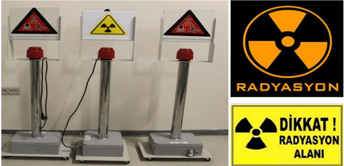
Resim 71: NDT testleri sırasında kullanılan sesli ve ışıklı uyarılar
