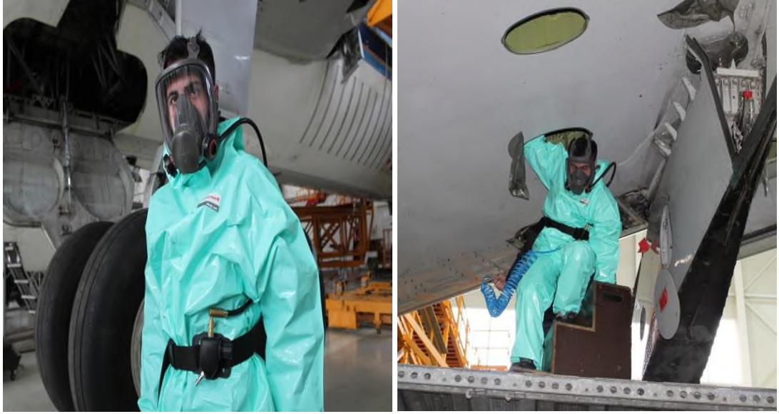
Resim 27: Yakıt tanklarında kullanılan solunabilir hava hattı sistemi
