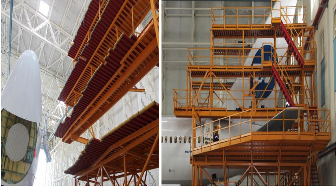
Resim 47: Manuel olarak ya da çekici araç ile hareket ettirilebilen kuyruk ve burun dockları
