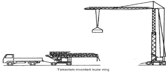
Şekil 15: Mobil Üniteler Üzerine Monte Edilmiş Kule Vinçler (Urul, 2013).
