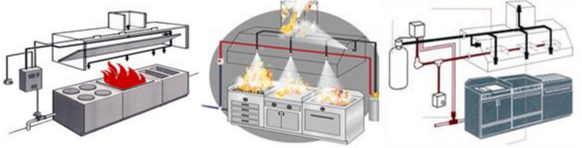
Resim-5.7. Mutfakta uygulanan sabit yangın söndürme sistemi-3 ( http://www.metropolyangin.com/web/sayfa3.php?sayfano=1 , Erişim:20 Aralık 2016)
