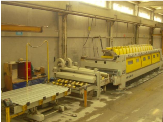
Resim 22: Polisaj makinesi. (Efendioğlu Mermer)
