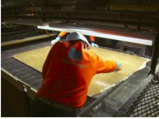
Resim 20: Çatlakların doldurulması (Efendioğlu Mermer)
