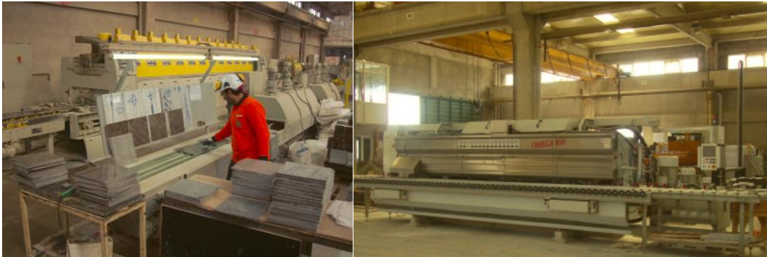
Resim 34: Seleksiyon (Efendioğlu Mermer) Resim 35: Pah makinesi (Efendioğlu Mermer)
