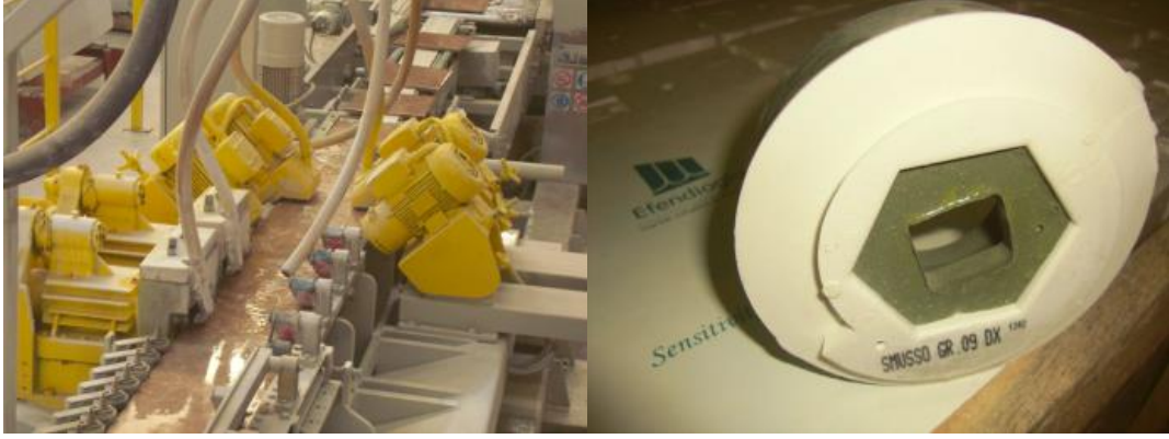
Resim 32: Kenar pah makinesi. (Efendioğlu Mermer) Resim 33: Pah abrasiv. (Efendioğlu Mermer)
