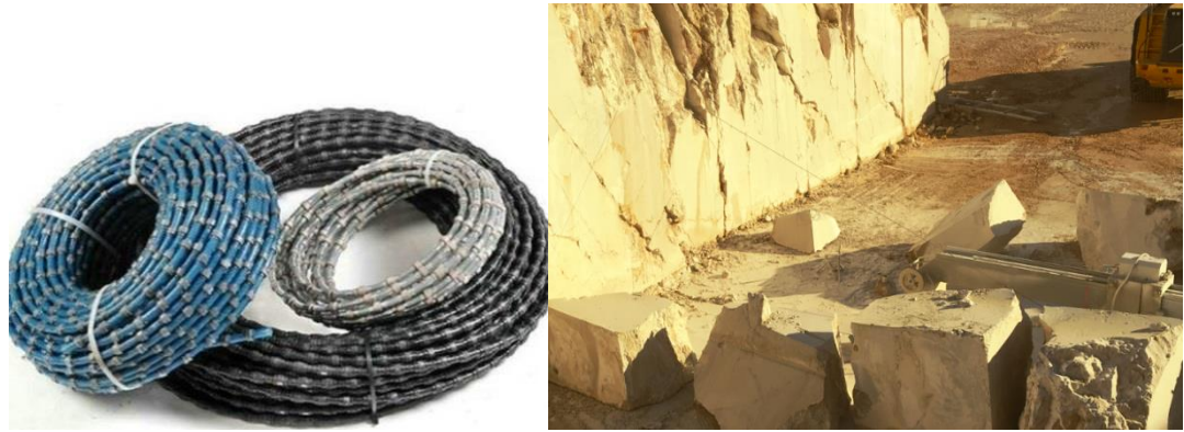
Resim 4: Kesme işleminde kullanılan elmas tel ve kesim işlemi. (Akar Maden mermer ocağı) Kaptanlar Açılı Elmas Telle Blok Mermer Kesme Makinası.
