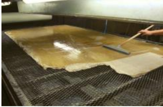
Resim 18: Epoksi uygulaması. (Efendioğlu Mermer)
