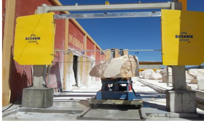
Resim 12: Elmas telli makine ile blok sayalaması. (düzeltilmesi) http://www.ozteknikmakine.com/tr-product-11--OZTKM_01_Sabit
