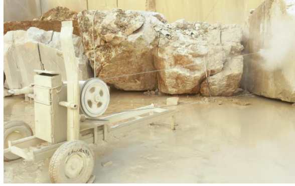
Resim 8: Sayalama yapılışı. (Akar Maden mermer ocağı) Kaptanlar aosm 25 elektrikli açılı otomatik sayalama makinası
