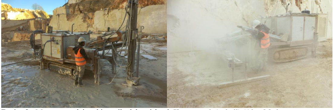
Resim 3 : Mermer sondaj makinası ile delme işlemi. Kaptan rock (paletli) (Akar Maden mermer ocağı)
