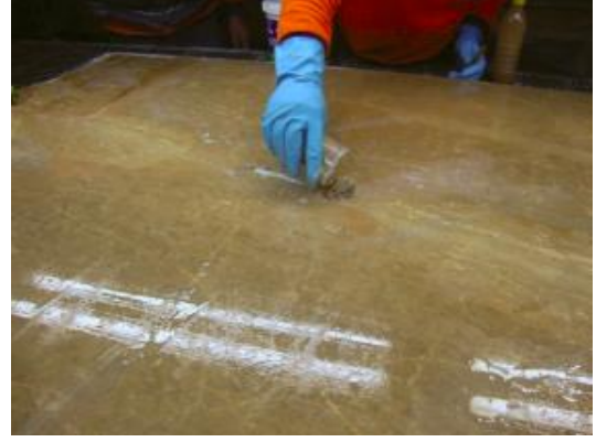
Resim 21: Küçük parçalar ile çatlak doldurma (Efendioğlu Mermer)
