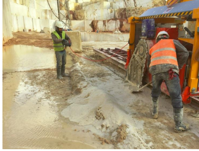
Resim 2: Kollu zincirli kesme makinesi ve kesme işlemi. 'Fantini' (Akar Maden mermer ocağı)
