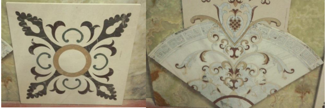
Resim 39: Su jeti ile kesilmiş ürünler. (Limra Mermer)
