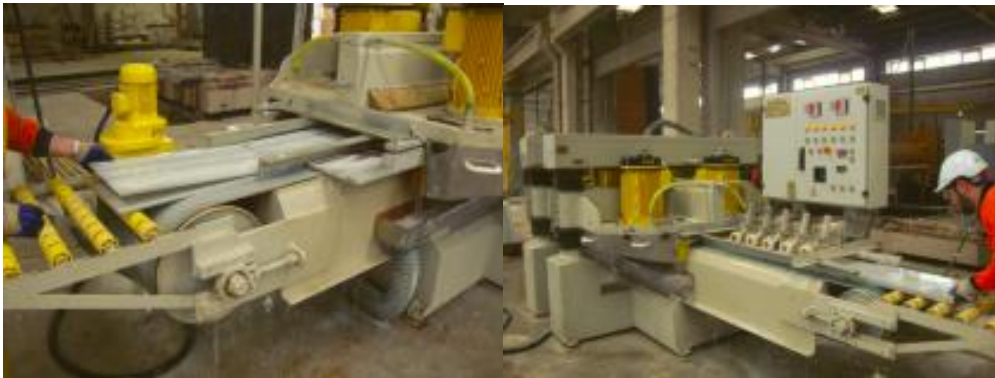
Resim 25: Orta yarma makinesi. (Efendioğlu Mermer)
