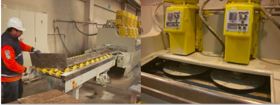
Resim 26: Kalibre işlemi. (Efendioğlu Mermer)
