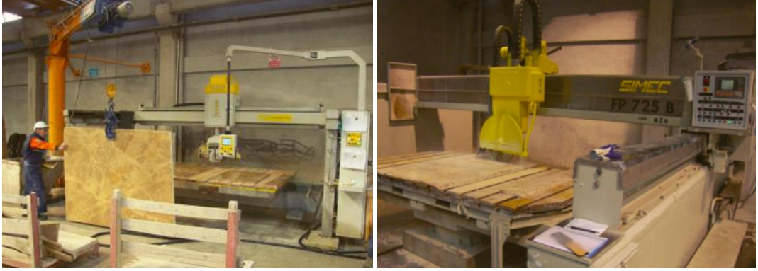
Resim 24: Köprü kesme makinaları. 'Brio- Simec' (Efendioğlu Mermer)
