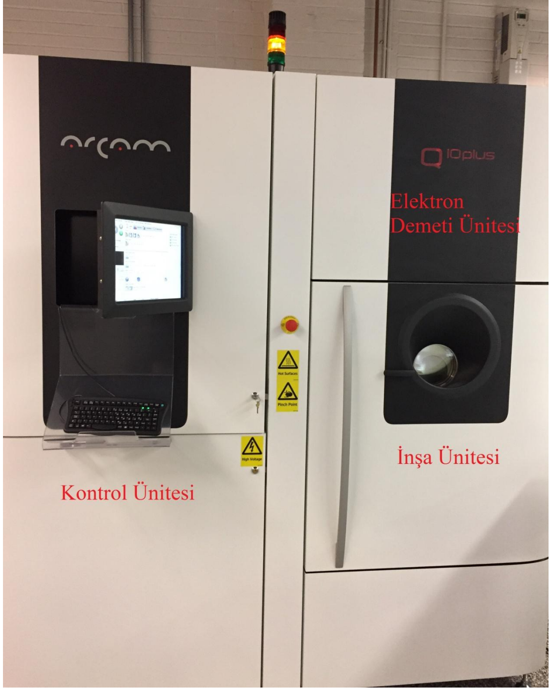
Resim 5. 2. Ni-Ti üretiminde kullanılan Q10Plus cihazı dış görünüşü ve üniteleri
