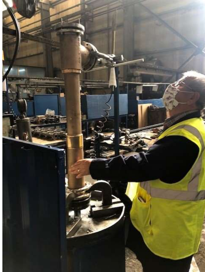
Şekil 5.8: Ejektör Sızdırmazlık Testi
