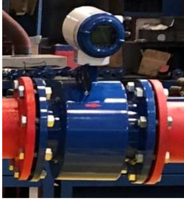
Şekil 5.12: DN150 mm Manyetik Debimetre
