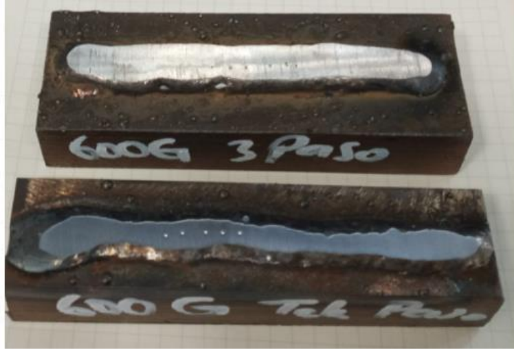
Şekil 11.5: Makro Sertlik Ölçümü Alınmış Numuneler
