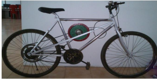
Şekil 2.3: Kinetik enerji depolama bisiklet uygulaması
