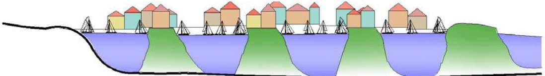
řekil 7: Kara parası ierisinin kazılarak oluřturulan konut ve yatların bir arada olduėu marina modeli (zkan, 2008)
