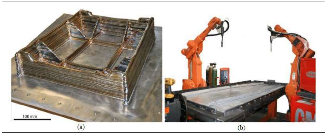
Şekil 3.2: a) Ti-6Al-4V harici iniş takımı tertibatı, b) 2.5mm alüminyum kanat direği uygulaması
