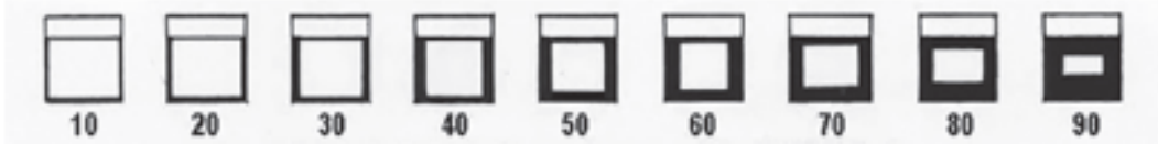
Şekil 6.7: Çentik darbe numunelerinin kırık yüzey % hesaplama standardı [73]
