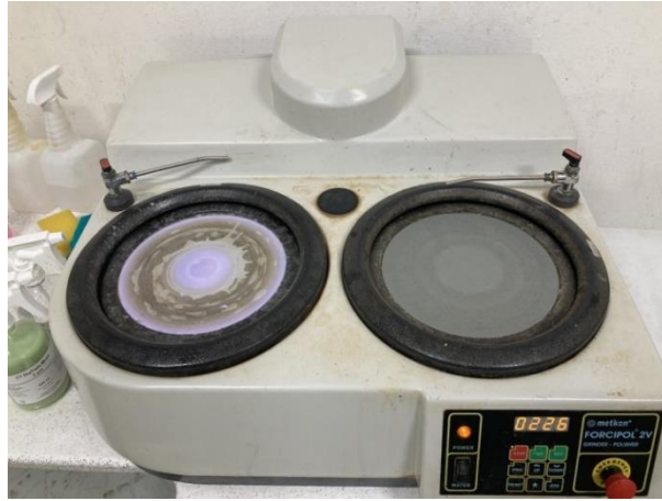
Şekil 5.17: Zımparalama ve parlatma cihazı
