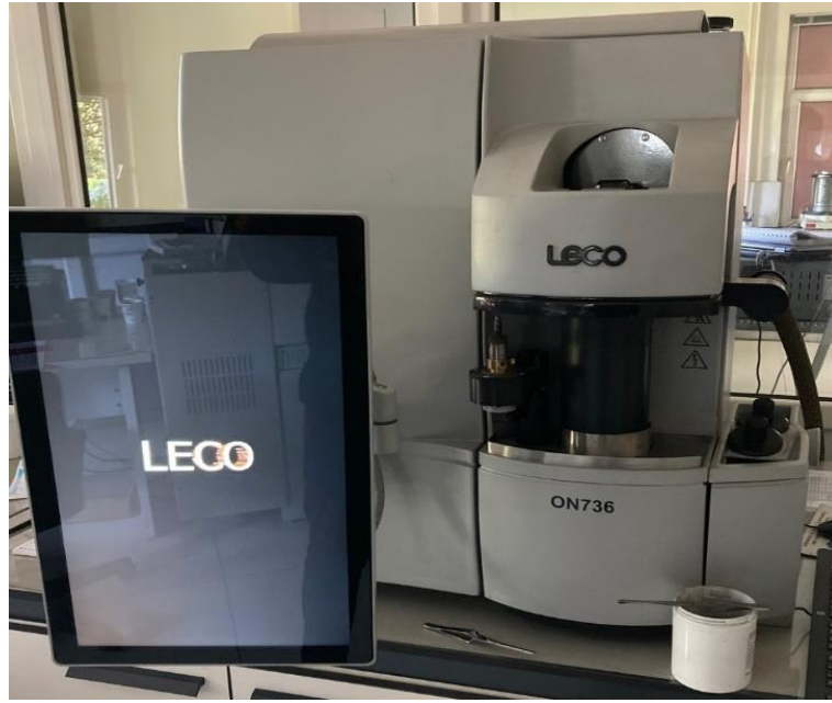
Şekil 5.27: N/O analiz cihazı
