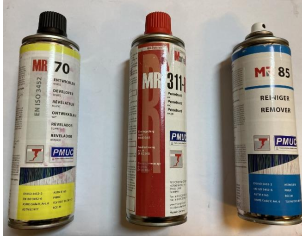
Şekil 5.7: Penetrant muayenede kullanılan sarf malzemelerin genel görünümü
