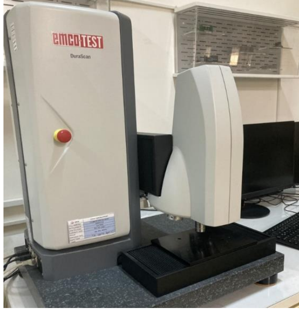
Şekil 5.16: Otomatik sertlik ölçme makinesi
