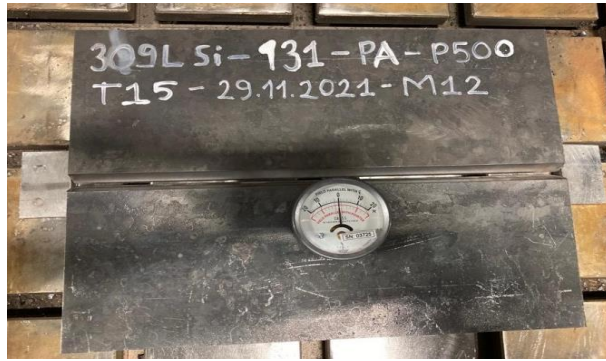
Şekil 5.4: Plakaların manyetiğini almak için kullanılan gaussmetre
