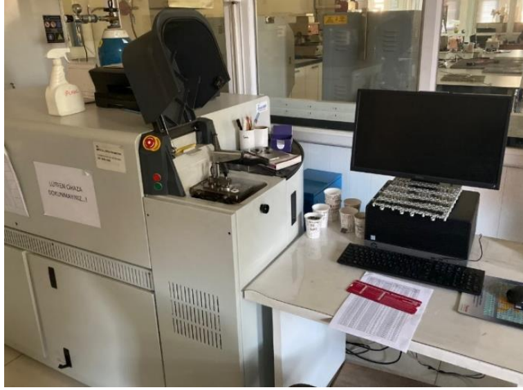
Şekil 5.25: Kimyasal analiz ölçüm cihazı (ARL)
