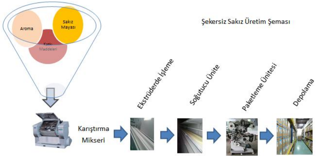
Şekil 2: Şekersiz sakız üretim aşmaları
