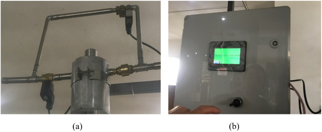
Şekil 59. ATAS model ölçekli prototip tasarım a) Yıkama ünitesi b) Otomasyon kontrol panosu
