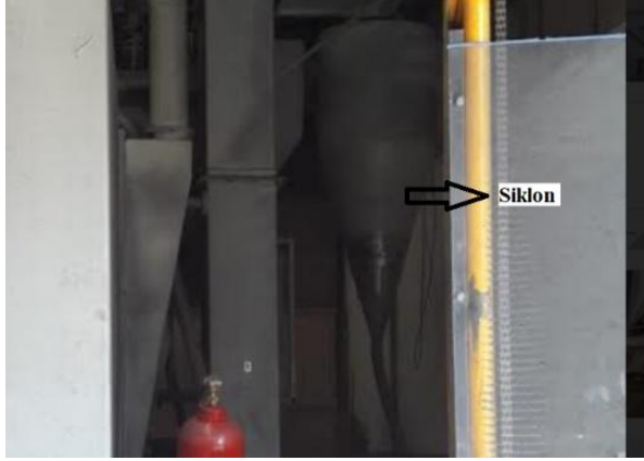
Şekil 7.22. Tesis 2 (Manisa) Kumlama Sistemi – Siklon
