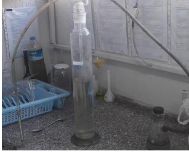
Şekil 7.28. Metalik Alüminyum Tayin Cihazı % Metalik alüminyum = \frac{\text{Dereceli kaptaki toplanan su miktarı (ml)}}{3,33} 13,80
