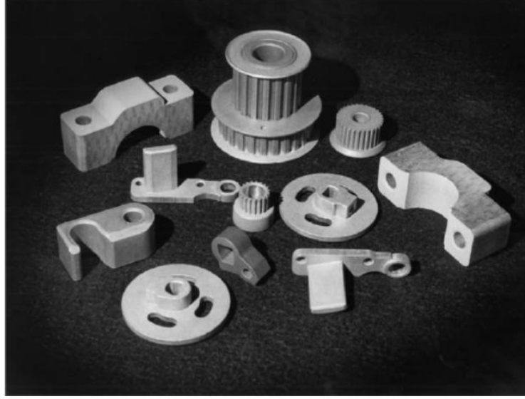
Şekil 5.9. Konvensiyonel Pres ve Sinterleme Tekniği İle Üretilmiş Çeşitli Parçalar (Totten ve Mackenzie 2003).
