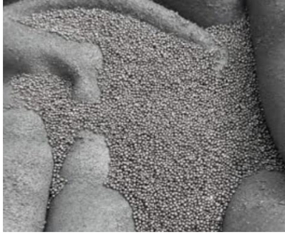
Şekil 7.13. Tesis □ (Manisa) Kumlama Ünitesinde Kullanılan Demir Bilyalar
