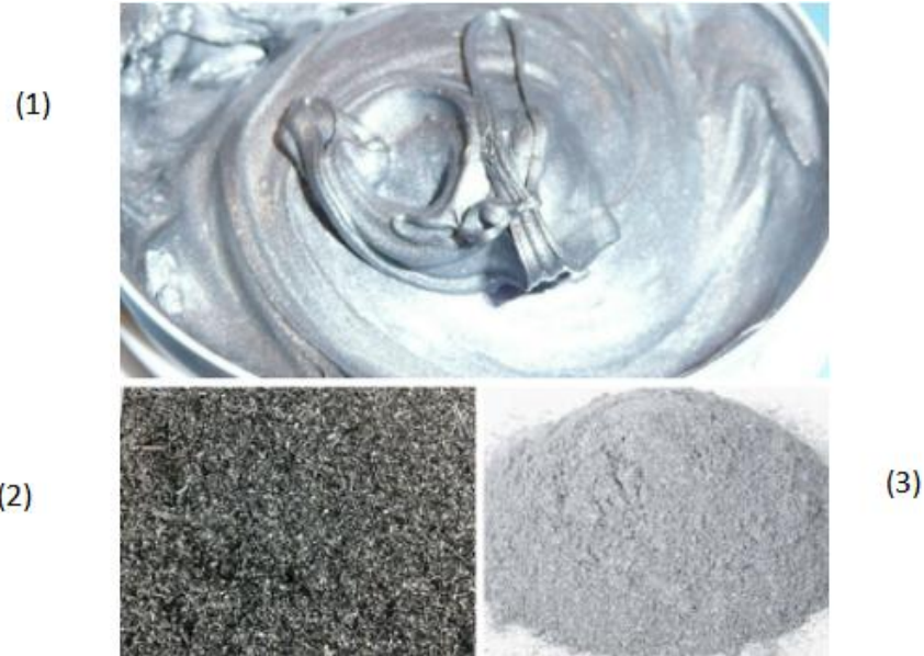
Şekil 5.11. (1) Alüminyum Pasta, (2) Alüminyum Pul, (3) Alüminyum Granül
