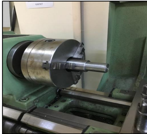
Şekil 2.20 : Kısa ve Emniyetli Bağlanmış İş Parçası
