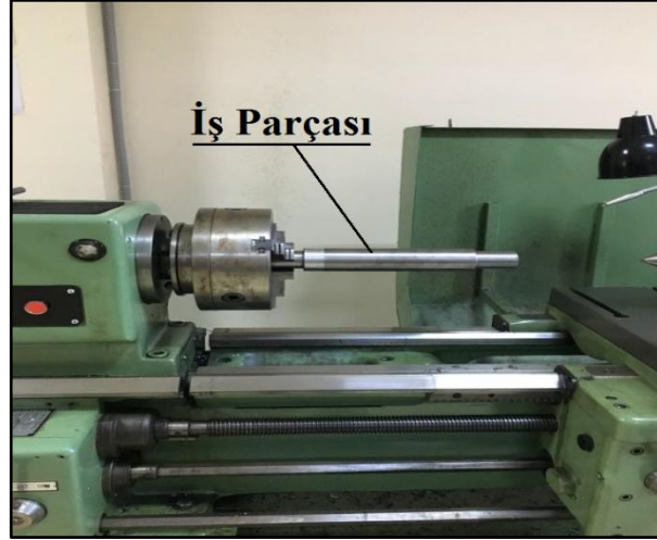
Şekil 2.21: Uzun ve Hatalı Bağlanmış İş Parçası
