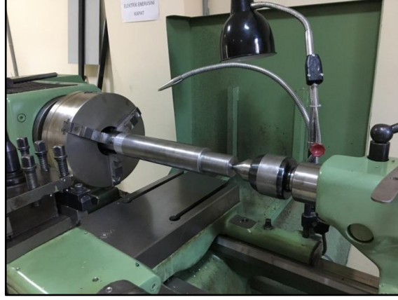
Şekil 2.22 : Ayna Punta Arasında Güvenli Bağlanmış İş Parçası
