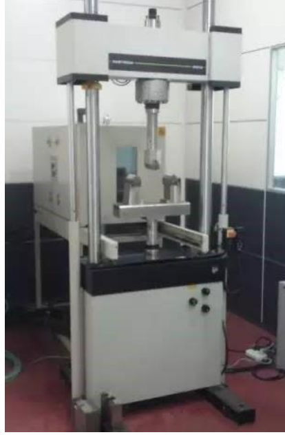
Şekil 3.7: CTOD Test Cihazı [47]
