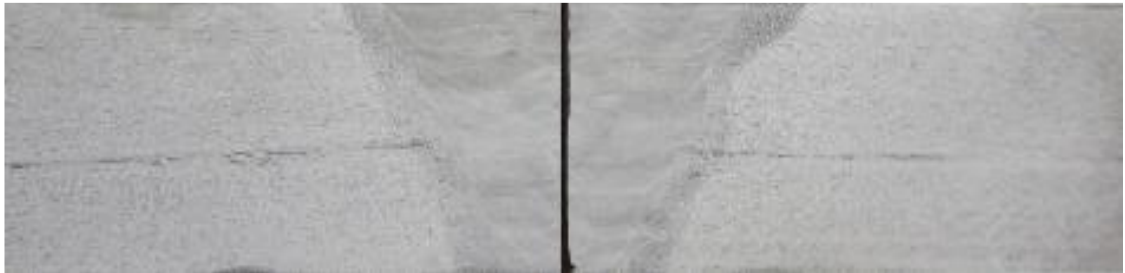
Şekil 4.5: 6357 Test Öncesi Metalografik Fotoğrafi
