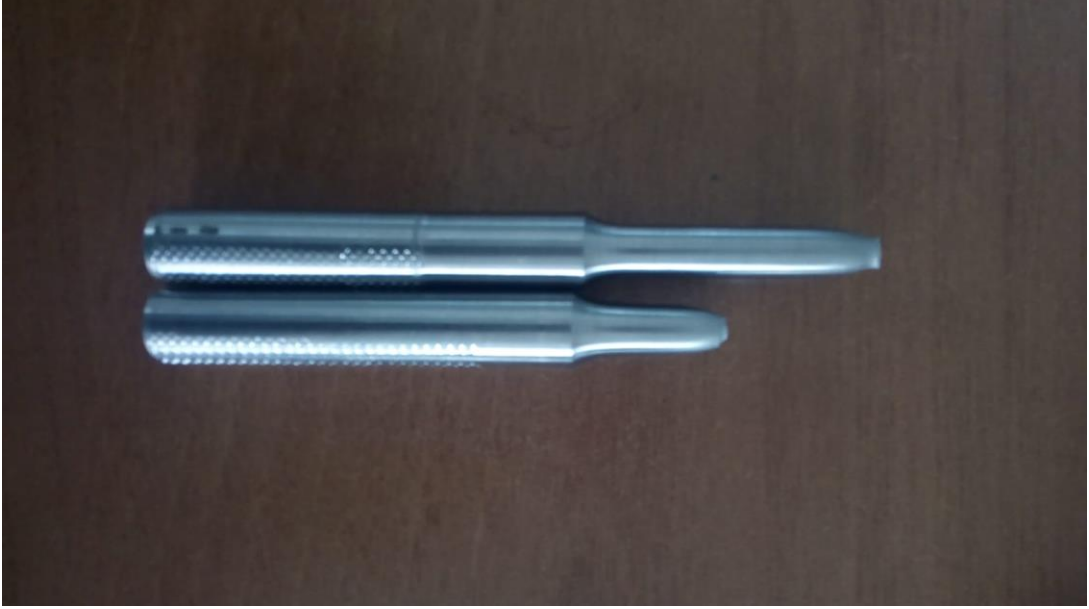
Şekil 3.12: Çekme testine sokulan deney numunesi
