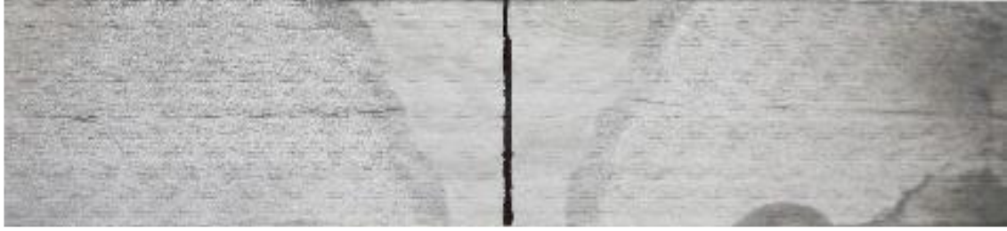
Şekil 4.6: 6360 Test Öncesi Metalografik Fotoğrafı
