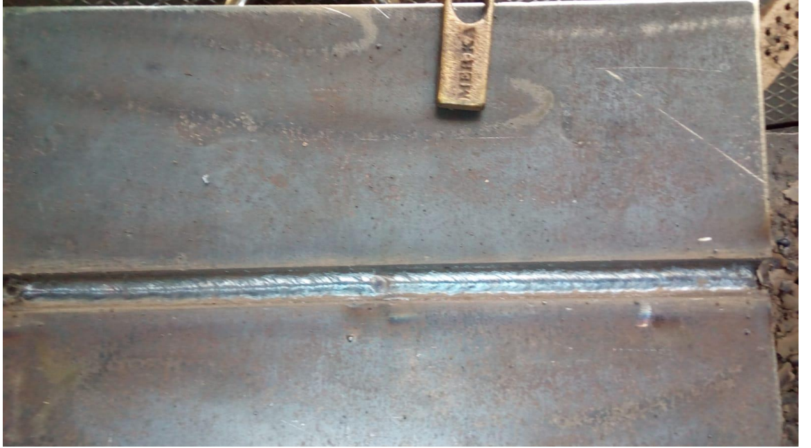
Şekil 3.11: Tempo B65 bazik elektrotu ile yapılan deney çalışması
