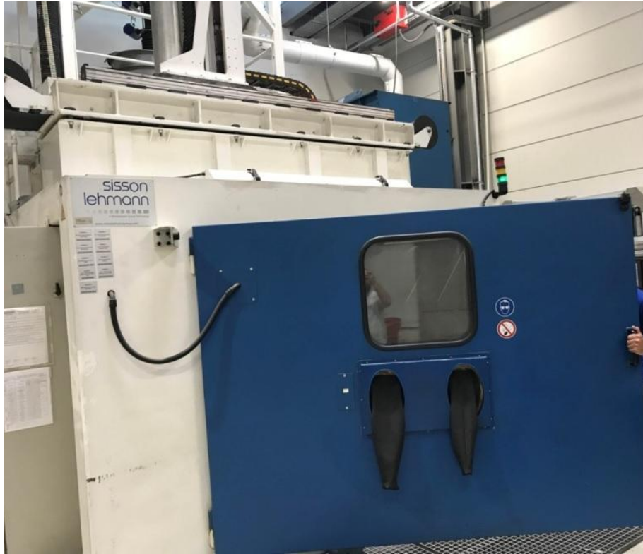
Şekil 4.3: Kale Havacılık Shot Peen Makinası
