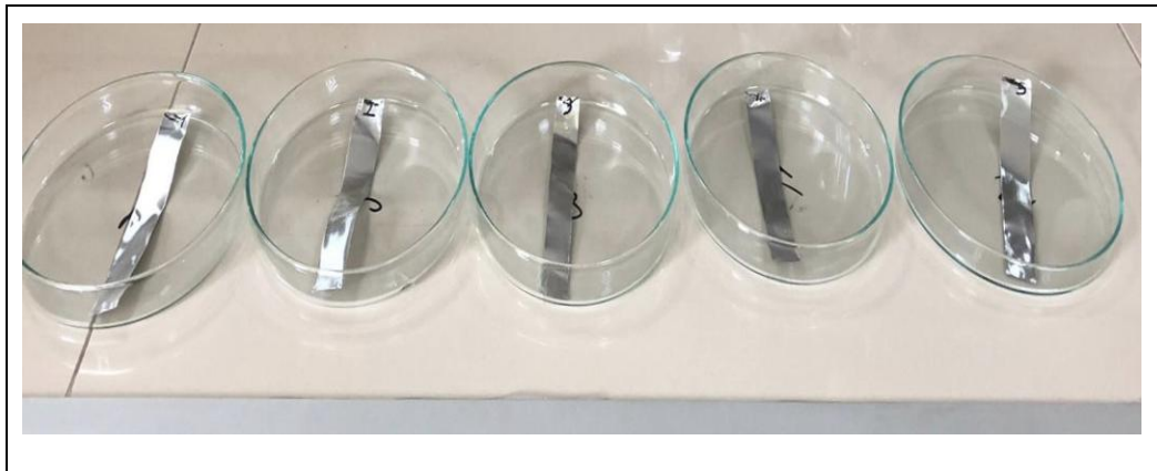
Şekil 3.2: NaOH Çözeltisine Yatırılmış Numuneler
