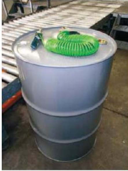
Şekil 5.12: Tipik Bir Solvent Kabı ve Topraklama Ekipmanı [17]
