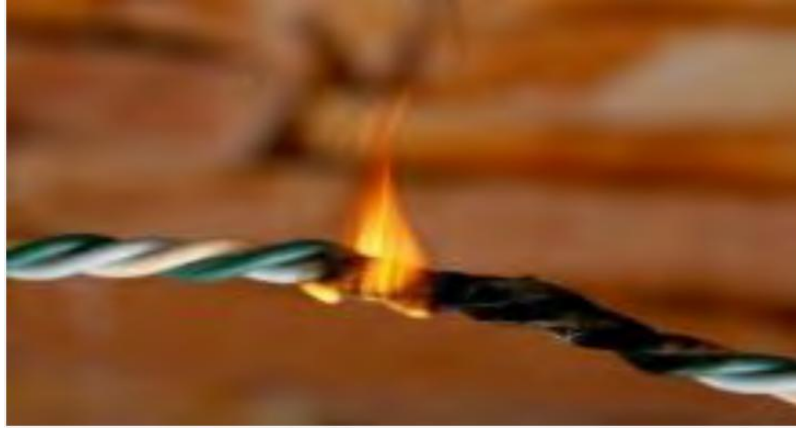
Şekil 5.16: Kabloda Aşırı Akıma Bağlı Isınma ve Tutuşma [19]
