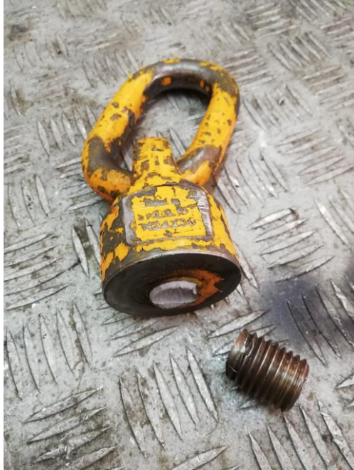
Şekil 5.48: Vaka 10 da Yaşanan Ramak Kaladaki Mapa Kırılması
