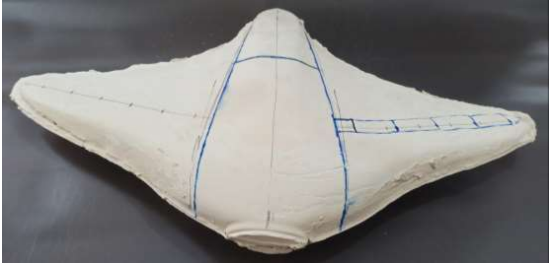
Şekil 3.6: Fiber kalıp içine dökülen alçı ile üretilen model
