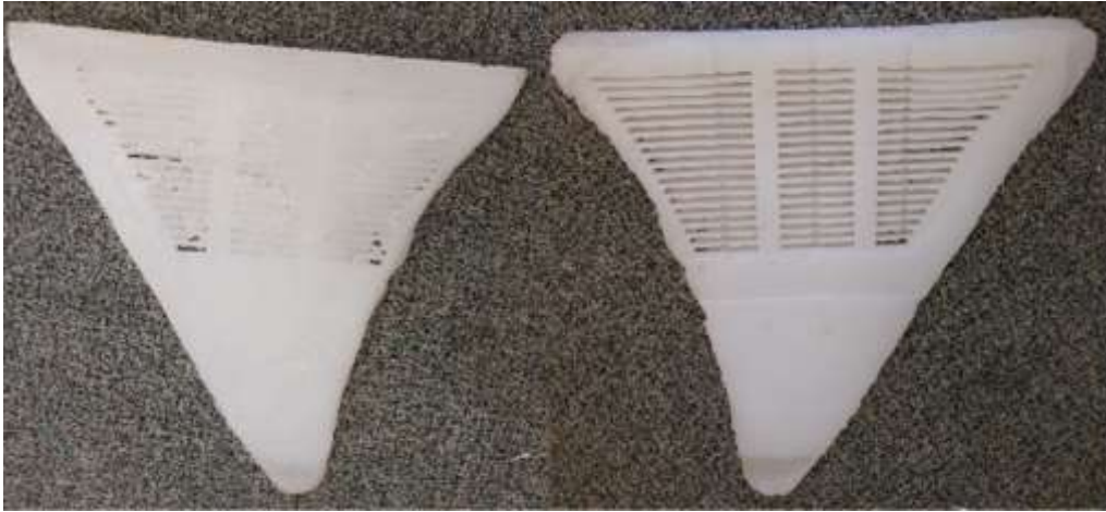
Şekil 2.15: Silikon kanat içerisindeki hava kanalları
