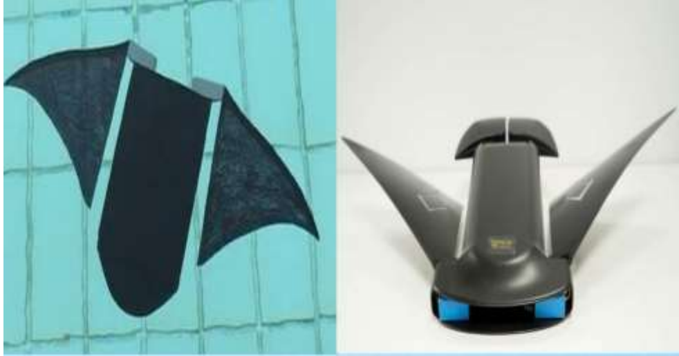
Şekil 2.8: Singapur Üniversitesi tarafından geliştirilen I. ve II. su altı robotu tasarımı arasındaki farklar
