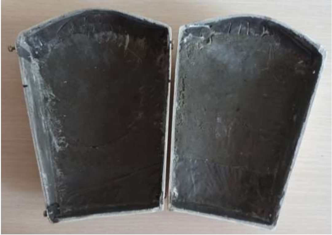
Şekil 3.7: Alçı kalıp ile elde edilen gövdenin görünümü
