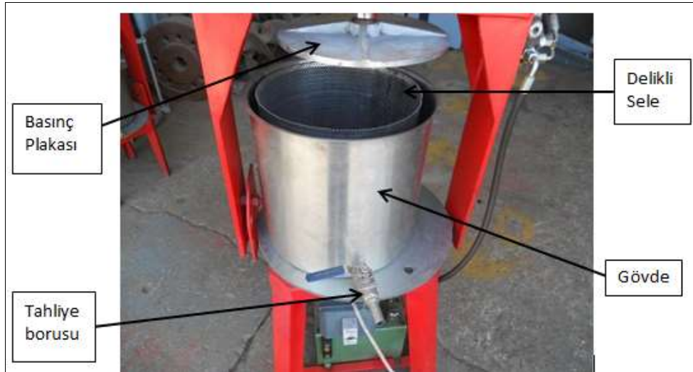
Şekil 4.3: Kireşçiler marka elektrikli üzüm sıkma makinesi
