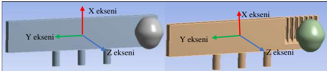
Şekil 6.35: Meyvenin düz palet (soldaki) ve bıçaklı palet (sağdaki) karşısında konumlandırılması
