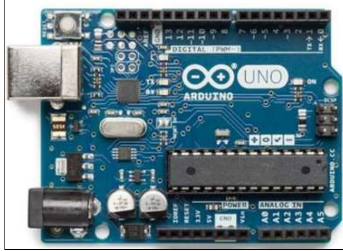
Şekil 5.20: Makinede kullanılan arduino uno - r3
