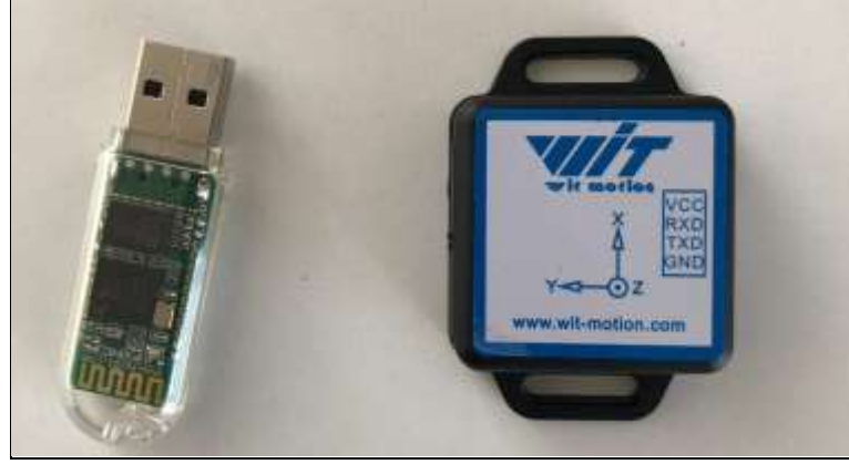
Şekil 7.1: Deneyisel analizde kullanılan IMU sensör (sağdaki) ve kablosuz bağlantı adaptörü (soldaki)
