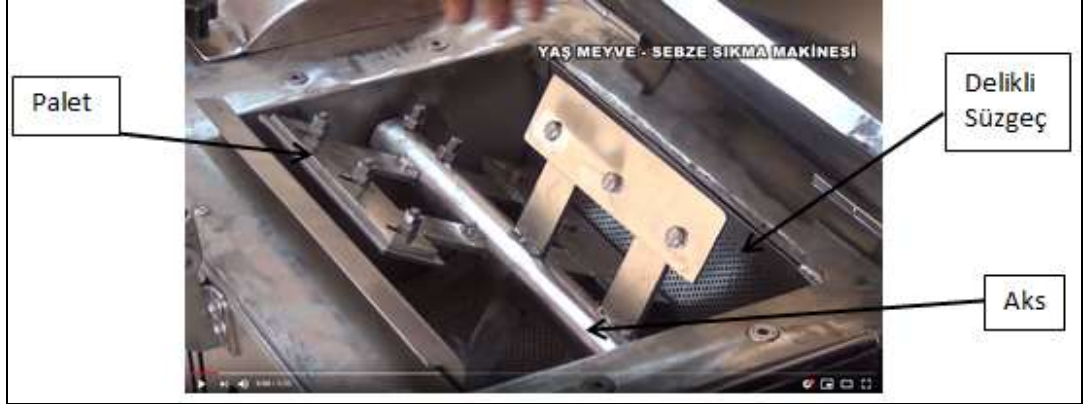
Şekil 4.2: Tulsan Smak-100000 Yaş Meyve Sebze ve Salça Makinası İç Yapısı
