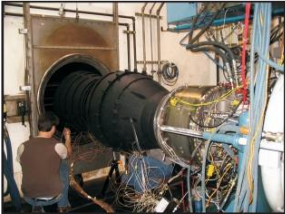
Şekil 2.4: Davis' in Uçak Gaz Türbini Baskılama Testi
