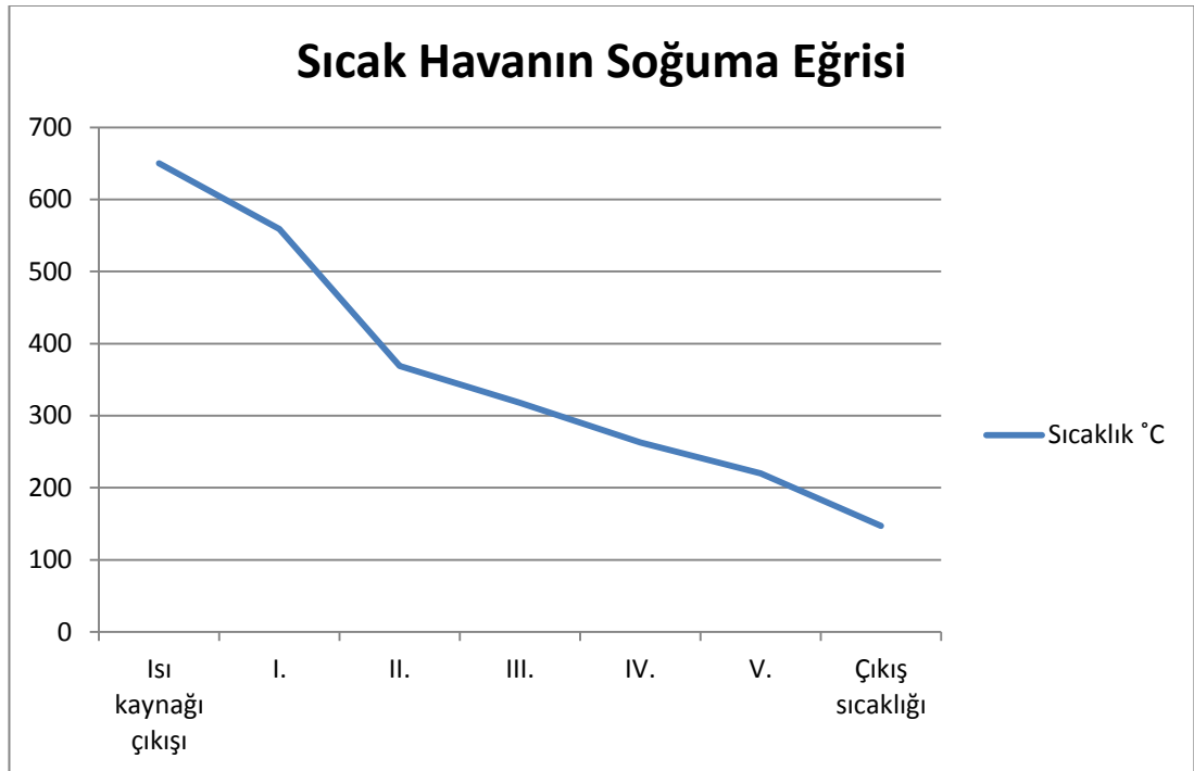
Şekil 3.5: Numunedeki Sıcak Havanın Soğuma Eğrisi
