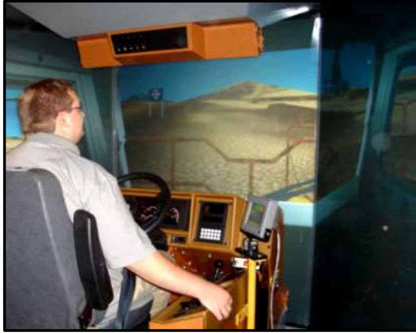
Şekil 2.3: Nakliye Kamyonu Şoförlüğü İçin Kullanılan Bir Eğitim Simülör Örneği
