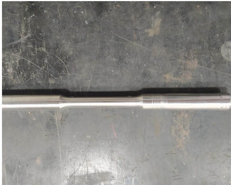
Şekil 11. 6:Her İki Numune İçinde Hazırlanan Çekme Test Numunesi
