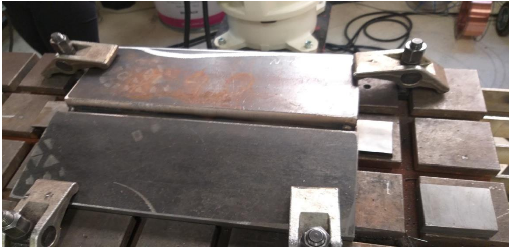
Şekil 10. 1:Test Parçasının Aparatlarla Sabit Tuturulması
