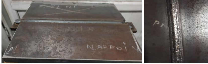
Şekil 12. 1:ELCOR R 81 Ni Rutil Özlü Tel ve ELCOR M 80 Ni Metal Özlü Tel Kaynağı Görüntüsü
