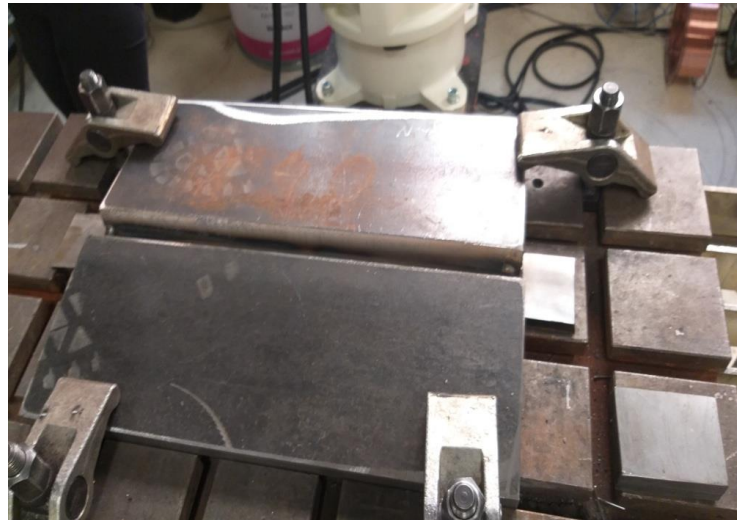
Şekil 8. 2: Kaynak Test Parçası Görünümü
