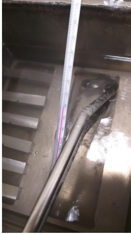
Şekil 11. 3: Test Numunelerini -30°C, -40°C ve -50°C'ye Soğutulması
