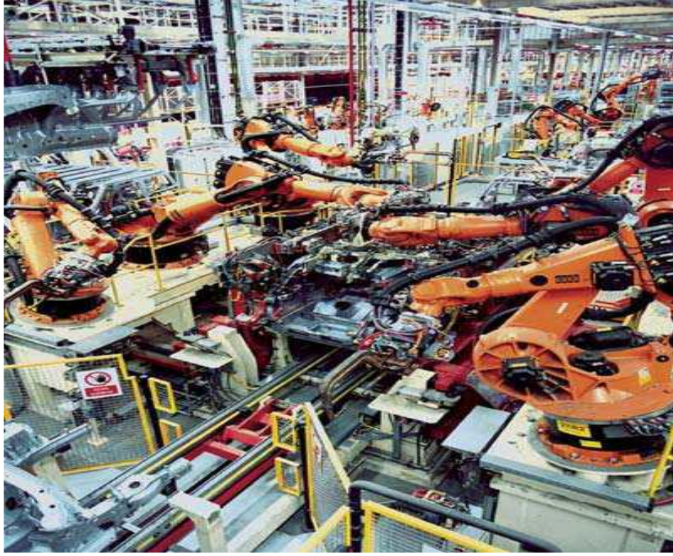
Şekil 5. 1: Kaynaklı Birleştirmede Sanayi Robotlarının Kullanımı[14]
