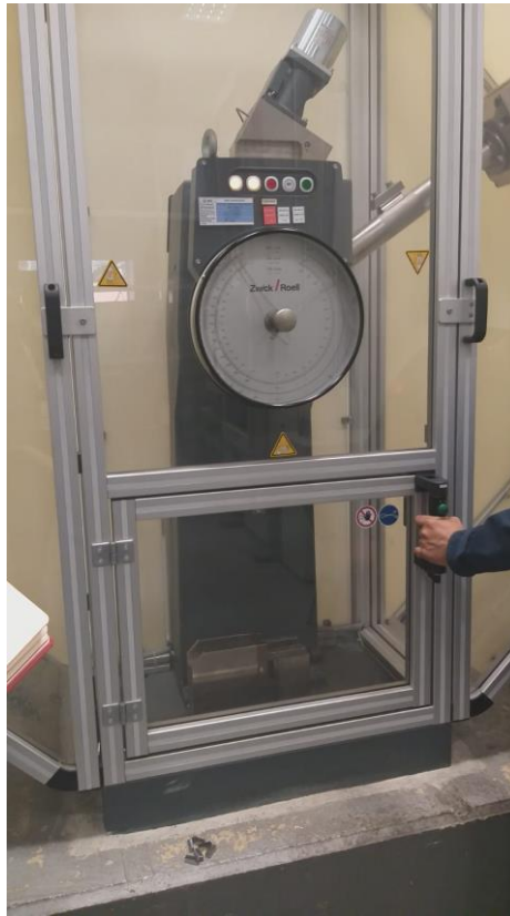
Şekil 11. 4: Çentik Test Deneyi Esnasında Bir Görüntü
