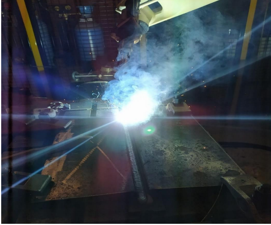
Şekil 10. 3: ELCOR R 81 Ni Rutil Özlü Telin Kaynağı Esnasından Bir Görüntü
