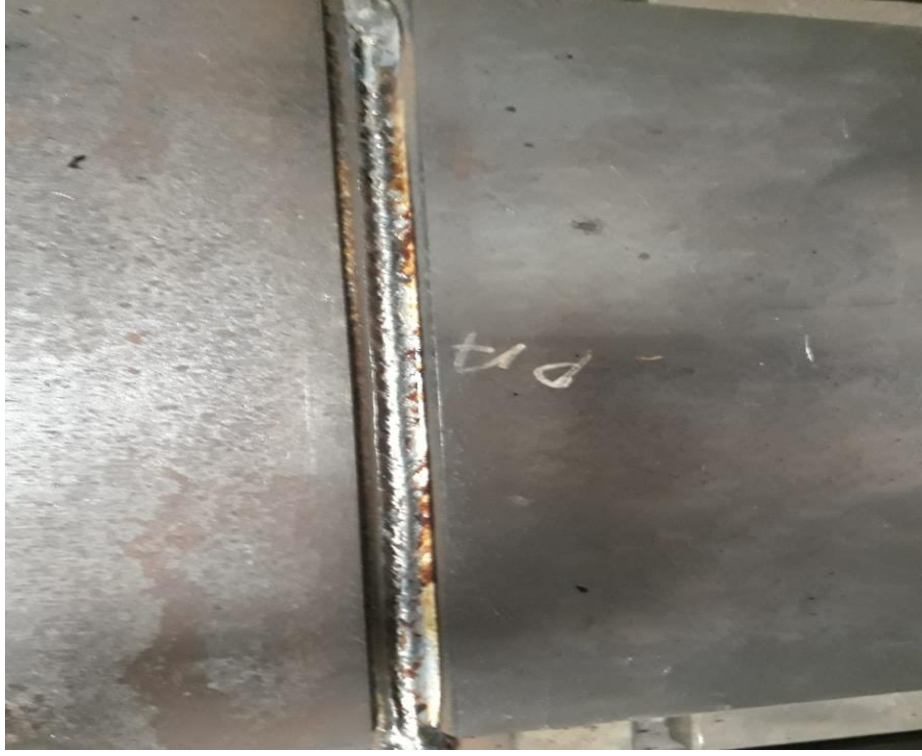
Şekil 10. 8: ELCOR M 80 Ni Metal Özlü Tel Kaynağında Ara Pasolarında Bir Görüntü
