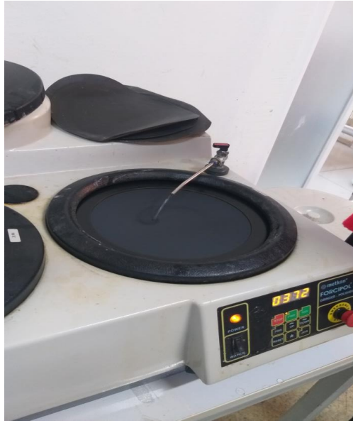
Şekil 11. 11: Zımparalama ve Parlatma için Kullanılan Cihaz
