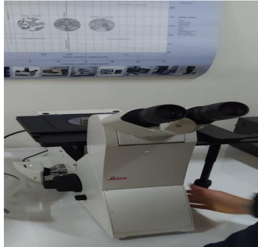
Şekil 11. 14:Işık Metal Mikroskop Cihazında Mikro Görüntülerin Alınması
