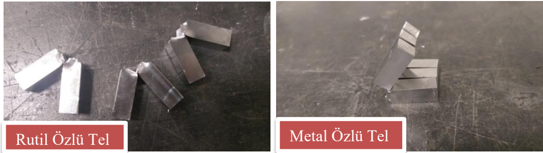
Şekil 9. 14: Rutil ve Metal Özlü Tel Kaynağının Çentik Darbe Testi Sonrası Numune Görüntüleri
