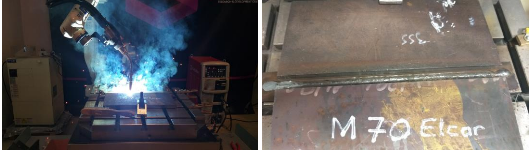
Şekil 8. 11: Metal Özlü Telin Kaynağı Esnasında Bir Görünümü
