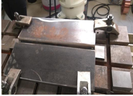
Şekil 8. 6: Test Parçasının Aparatlarla Sabit Tutturulması
