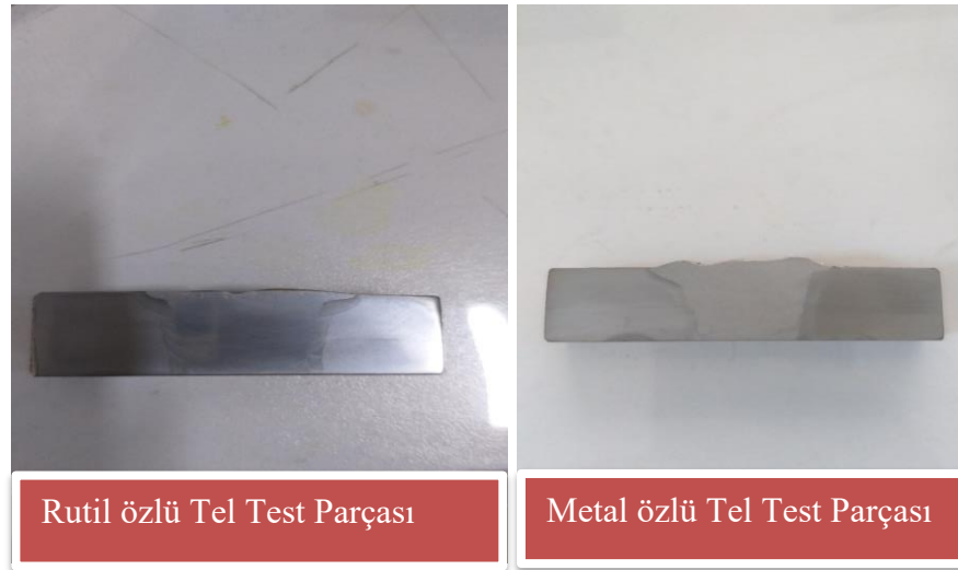
Şekil 9. 18: Dağlama Sonrası Rutil ve Metal Özlü Telin Test Parçalarının Görünümü
