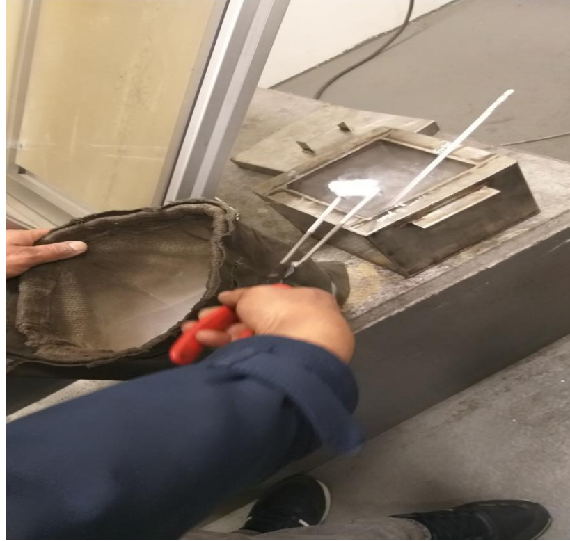
Şekil 9. 13: Test Numunelerini -30°C, -40°C ve -50°C'ye Soğutulması
