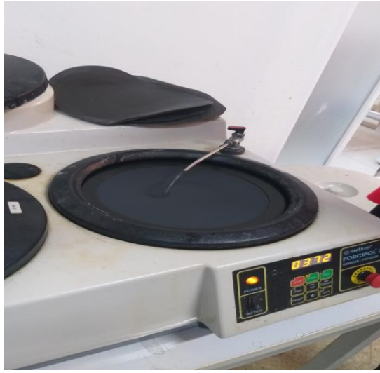
Şekil 9. 17: Zımparalama ve Parlatmada Kullanılan Cihaz
