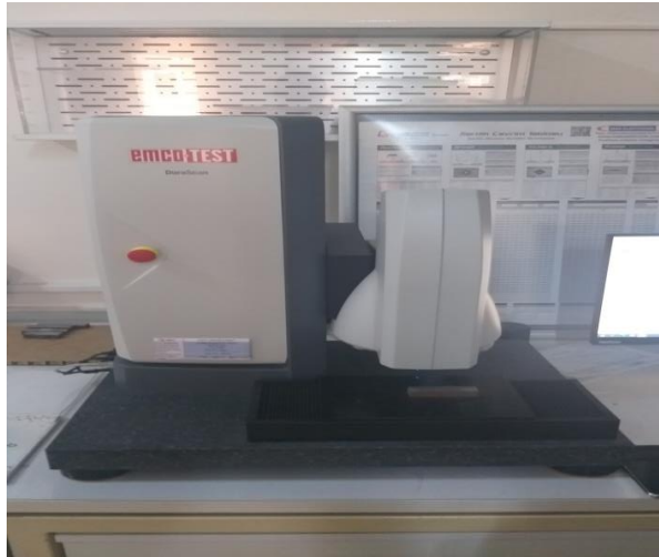
Şekil 9. 29: Sertlik Testinde Kullanılan Test Cihazı
