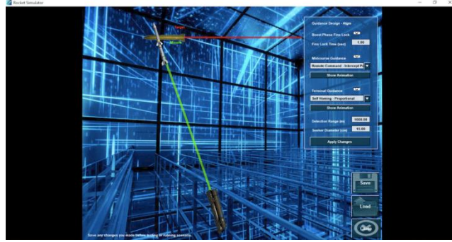
Şekil 4.22: Atgm_1 Füzesinin Uzaktan Komuta - Kesişim Noktası Güdüm Sistemi
