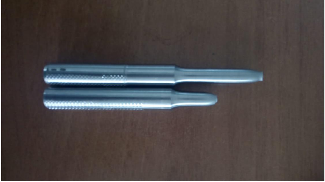
Şekil 3.12: Çekme testine sokulan deney numunesi
