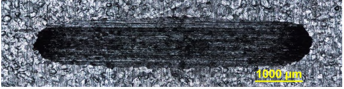
Şekil 4.40: 0,5 Bar ile Dövülen 5N Aşındırma Yapılan Numune Görüntüsü
