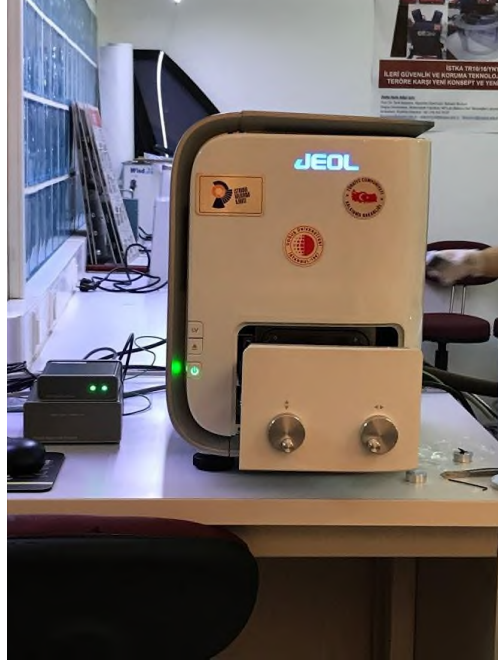
Şekil 4.8: Jeol Marka SEM Cihazı (kullanılan cihaz)
