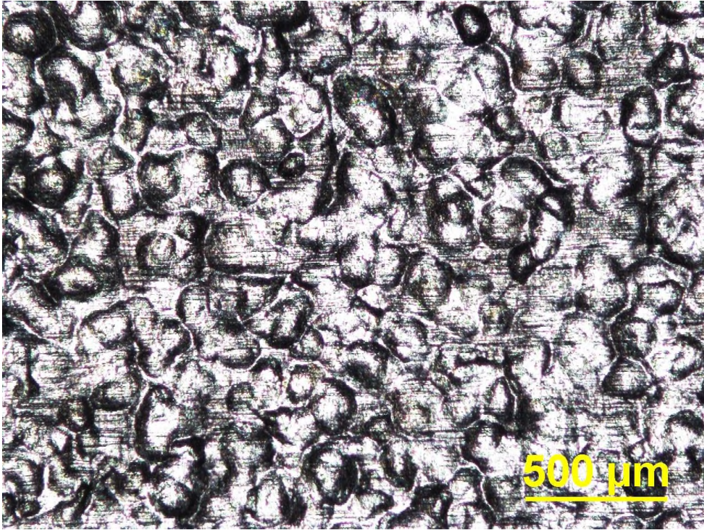
Şekil 4.44: 1 Bar ile Dövülen Numune Görüntüsü
