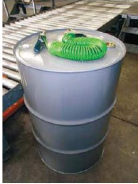
Şekil 5.12: Tipik Bir Solvent Kabı ve Topraklama Ekipmanı [17]
