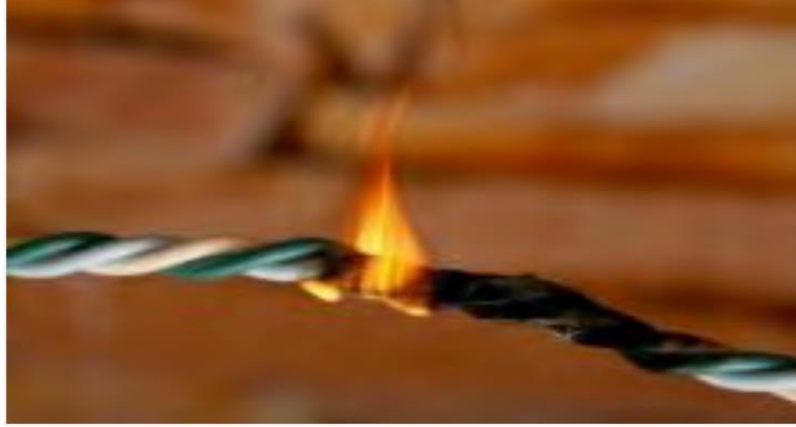
Şekil 5.16: Kabloda Aşırı Akıma Bağlı Isınma ve Tutuşma [19]
