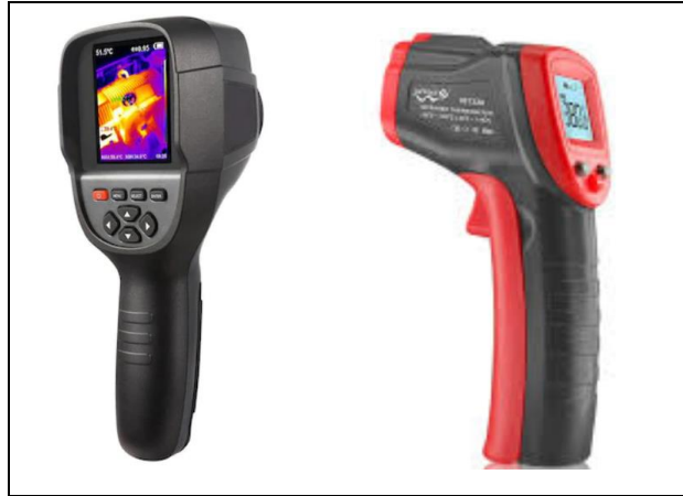
Şekil 5.15: Termal Kamera ve Lazerli Isı Ölçer
