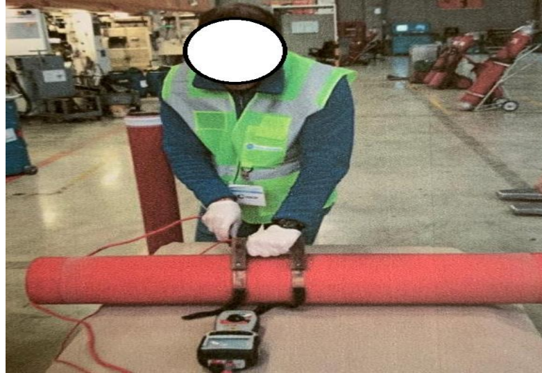
Şekil 6.3 : Sleeve Yüzey ve Yalıtım Direnç Ölçümü
