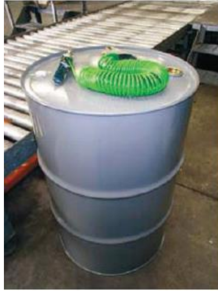
Şekil 5.12: Tipik Bir Solvent Kabı ve Topraklama Ekipmanı [17]
