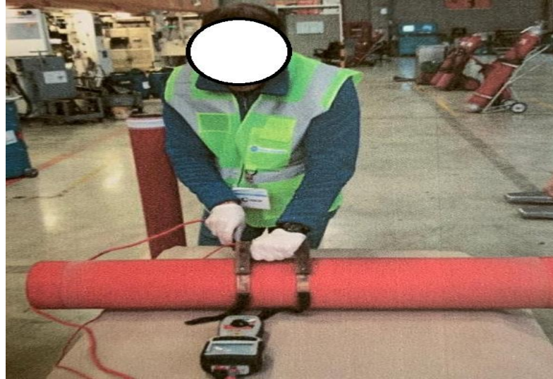
Şekil 6.3 : Sleeve Yüzey ve Yalıtım Direnç Ölçümü
