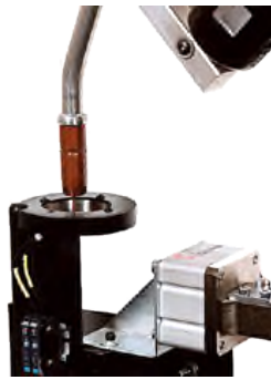
Resim 4. 30 Dokunma Yöntemiyle Üç Boyutta Kaçıklığın Ölçülmesi
