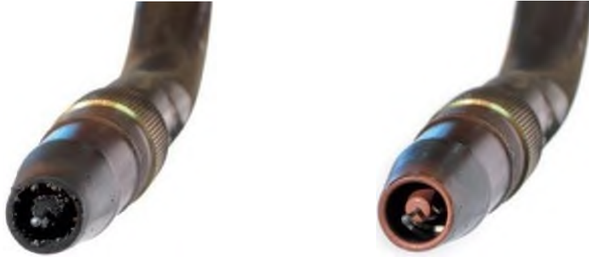
Resim 4. 21 Torç Temizlenmeden Önce ve Temizlendikten Sonra Görünüşü
