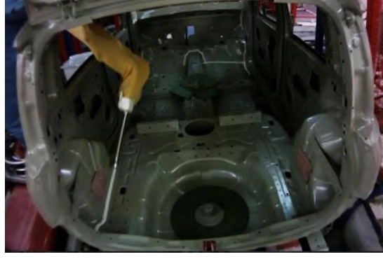
Resim 2. 5 FIAT Otomobil Fabrikası İç Conta Uygulama Prosesi
