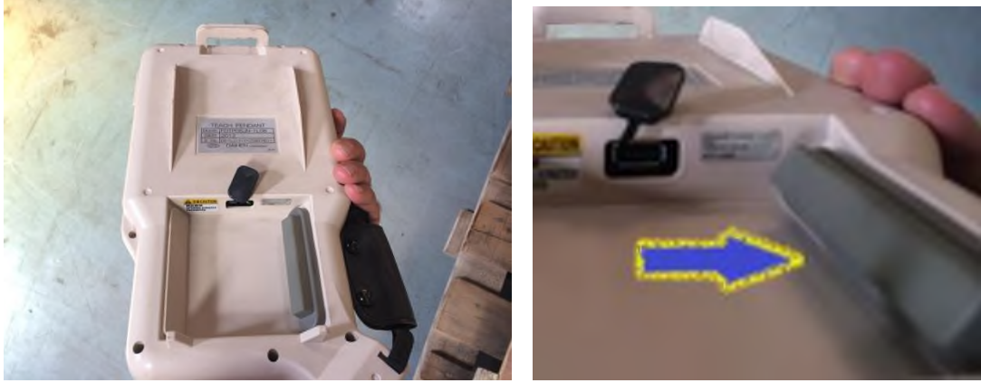
Resim 4. 10 El Terminali Ölü Adam Sviçi (Dead Man Switch)
