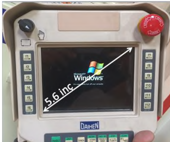
Resim 4.14 Windows Tabanlı İşletim Sistemine Sahip 5.6 inç El Terminali
