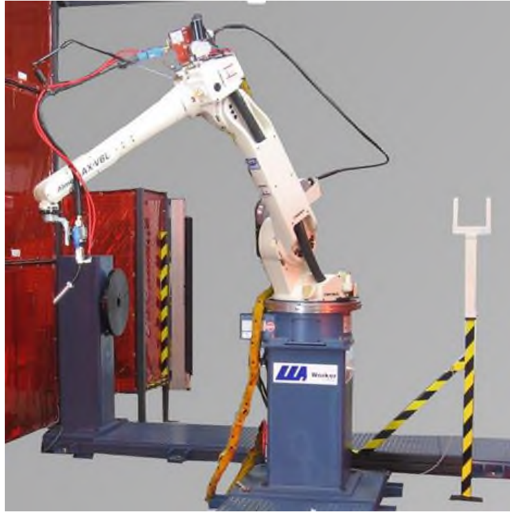
Resim 4. 32 Kalibrasyon Ekipmanının Hücredeki Yerleşimi
