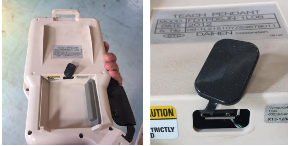
Resim 4.13 El Terminali Arkasında Yedekleme için USB Arayüzü
