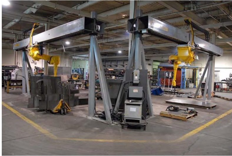
Resim 4. 25 Gantry Kaynak Robot Sisteminde Yer Kazancı
