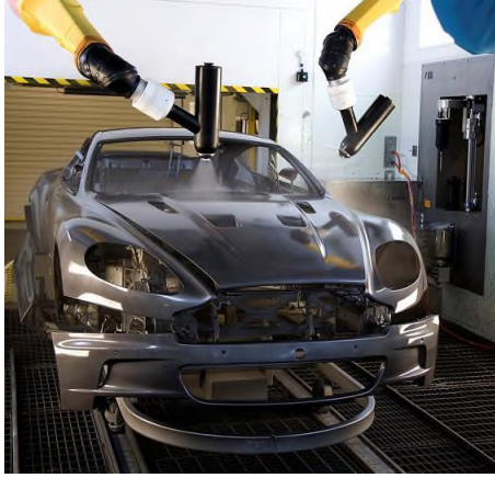
Resim 2. 7 Taşıt Kaportasının Boyanmasında Görev Alan Robotlar
