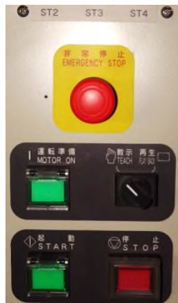
Resim 4. 42 Örnek Bir Operasyon Kutusu ve Acil Durdurma Butonu
