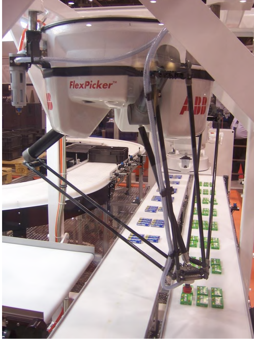
Resim 2. 3 ABB Flexpicker Sakız Fabrikası Paketleme Uygulaması
