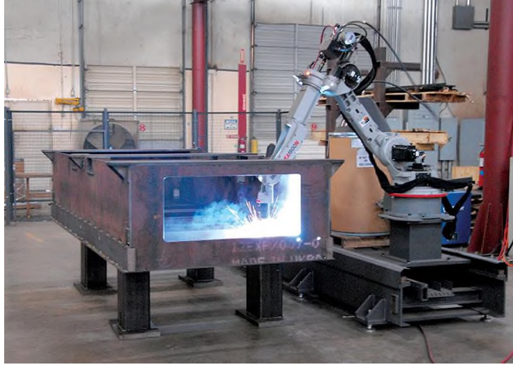
Resim 4. 28 Çukur Kaynağında Erişim Arttırımı için Slider Kullanımı
