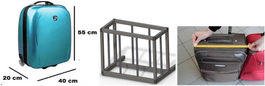
Şekil 1-1 Yolcu bagajı ve mevcut boyut ölçüm metotları
