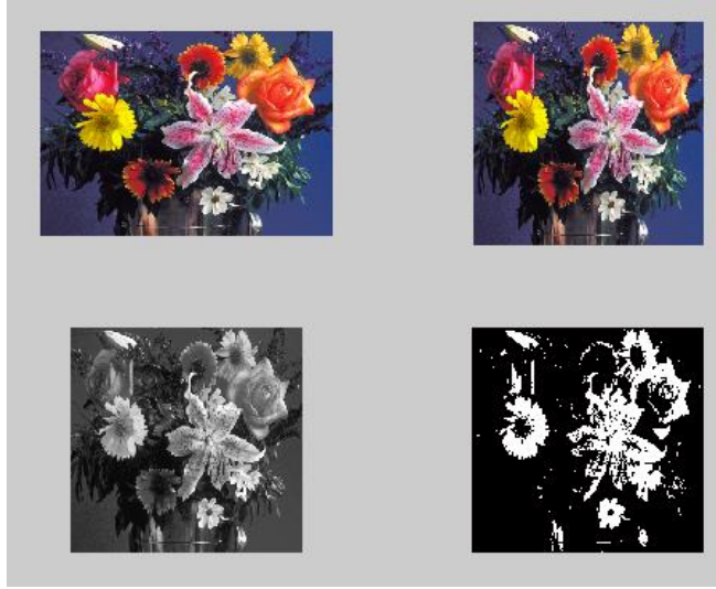
Şekil 4-5 MATLAB’de RGB görüntünün gri ve ikilik formata çevrilmesi
